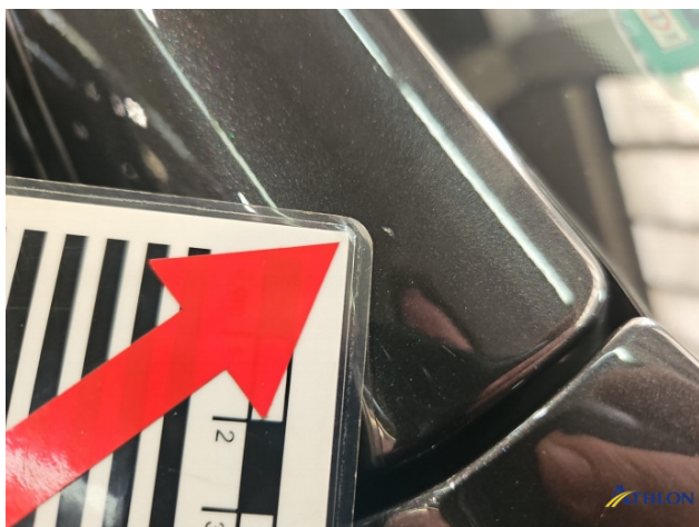
9. A-Säule Vorne - Rechts Steinschlag
