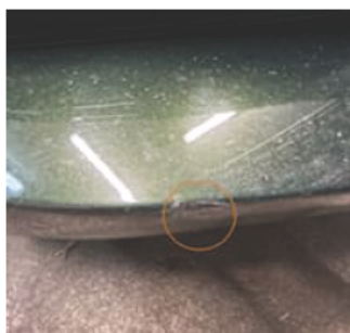
7.4.1 - Stötfångare fram Lackskada
