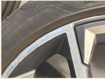
6.3.3 - Fälg höger bak :: Lagning: Fälgskrap 5cm Sommar 18-19"
