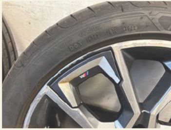
6.3.1 - Fälg höger fram :: Lagning: Fälgskrap 5cm Sommar 18-19"
