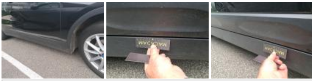
Sill trim R, Scratch(es), Replace
