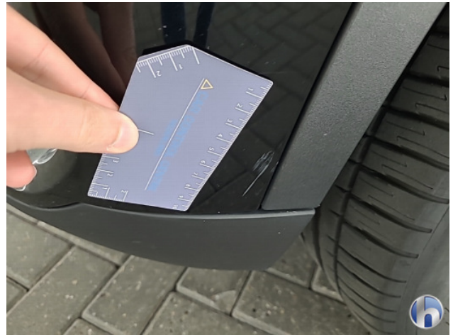
1. Diverse Gebruikssporen - Aanvaardbaar
