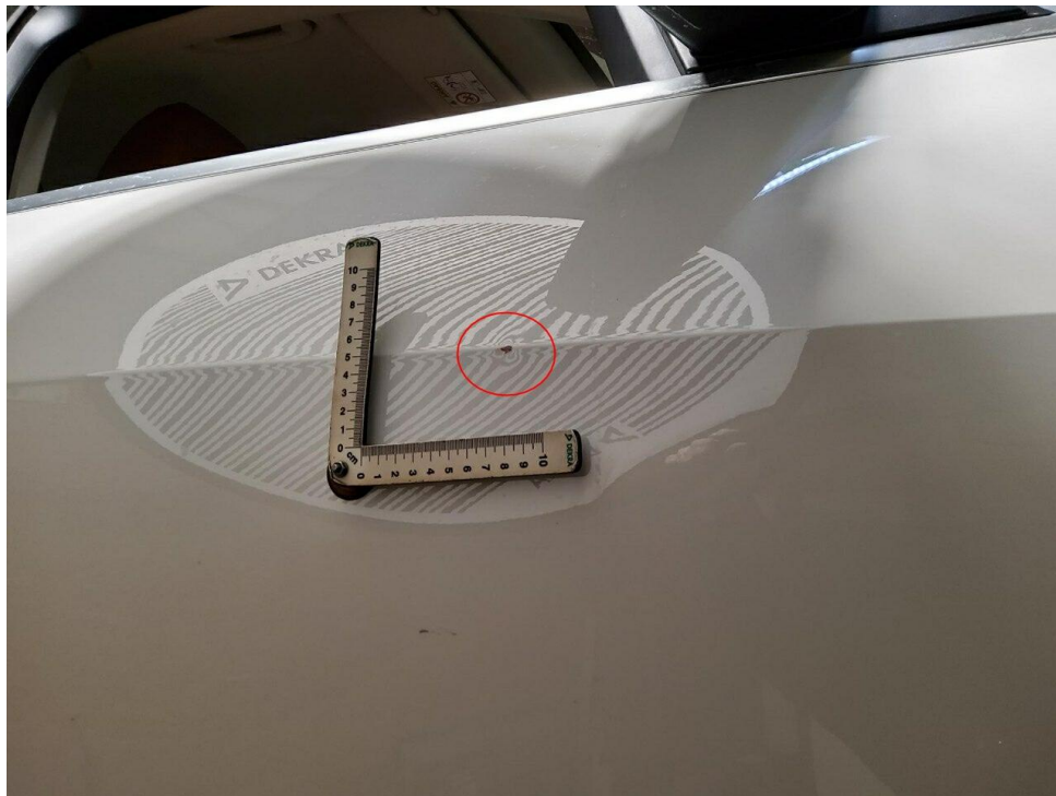
Bild 9 : Tür vorne rechts, eingedellt m. Lackbeschädigung, instandsetzen und lackieren mit Lackaufbau
