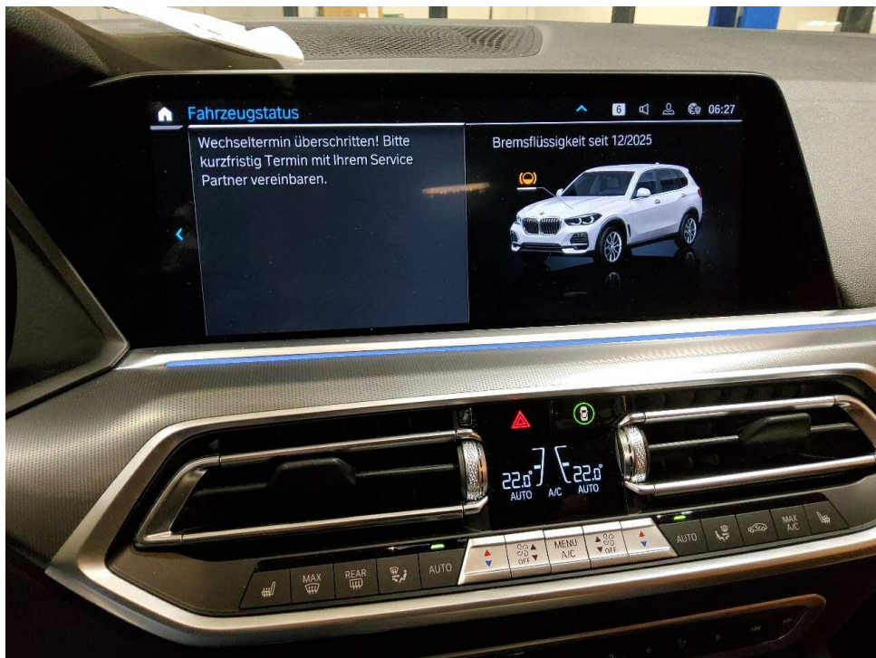
Bild 14 : Bremsflüssigkeit, Wechseltermin überschritten, Wechsel durchführen
