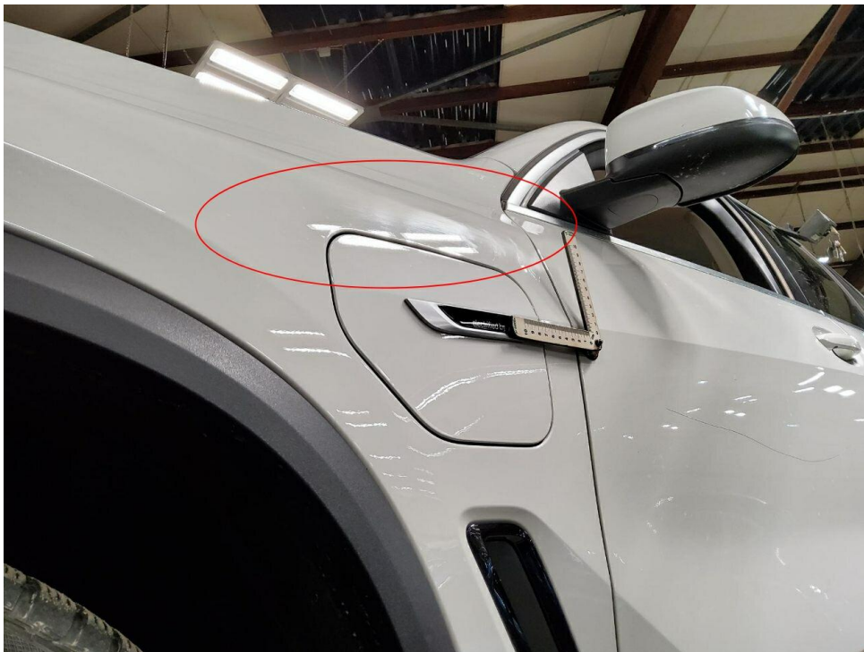
Bild 12 : Kotflügel vorne links Lackierung, Oberflächenkratzer , Gebrauchsspur
