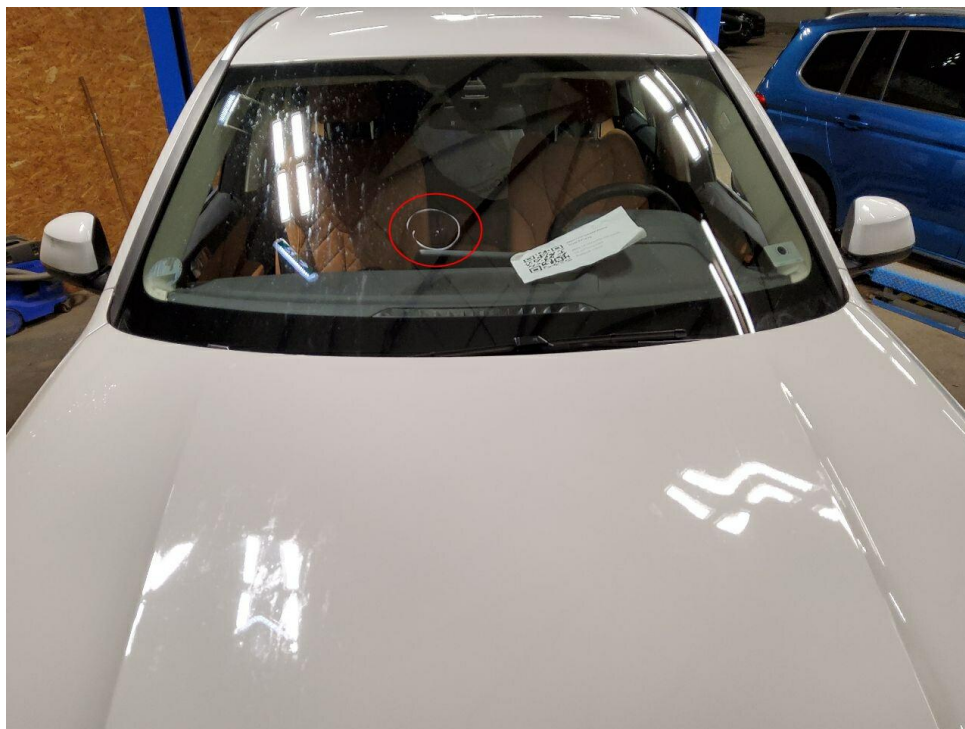
Bild 15 : Frontscheibe, Steinschlag mit Rissbildung
