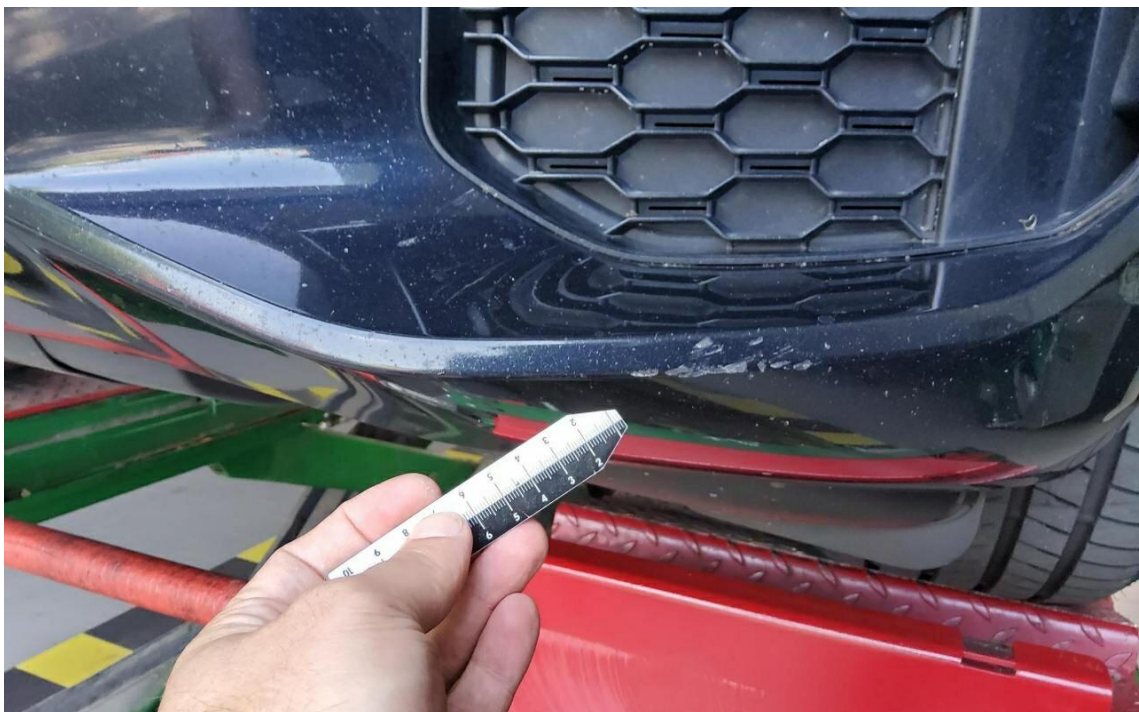
Bild 16 : Stoßfänger vorne Lackierung, zerkratzt, smart repair
