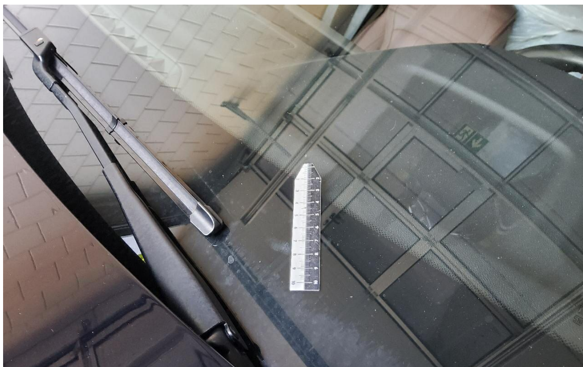
Bild 20 : Steinschlag mit Rissbildung Randbereich
