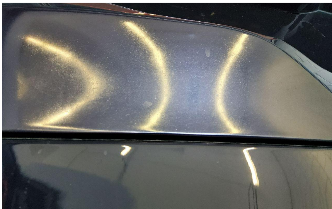
Bild 22 : Heckklappe deutliche Rep. Spuren sichtbar
