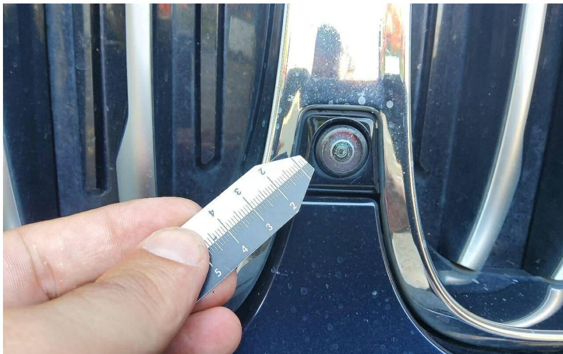
Bild 21 : Kamera Stoßfänger vorne viele Steinschläge
