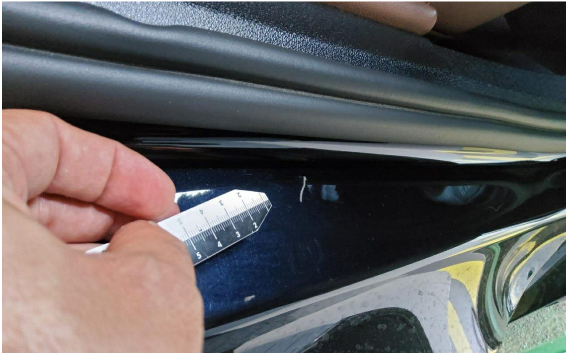
Bild 15 : Tür hinten rechts Einstieg Lackierung, zerkratzt, Gebrauchsspur
