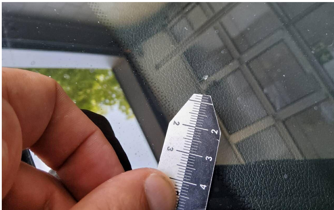
Bild 19 : Steinschlag mit Rissbildung Randbereich
