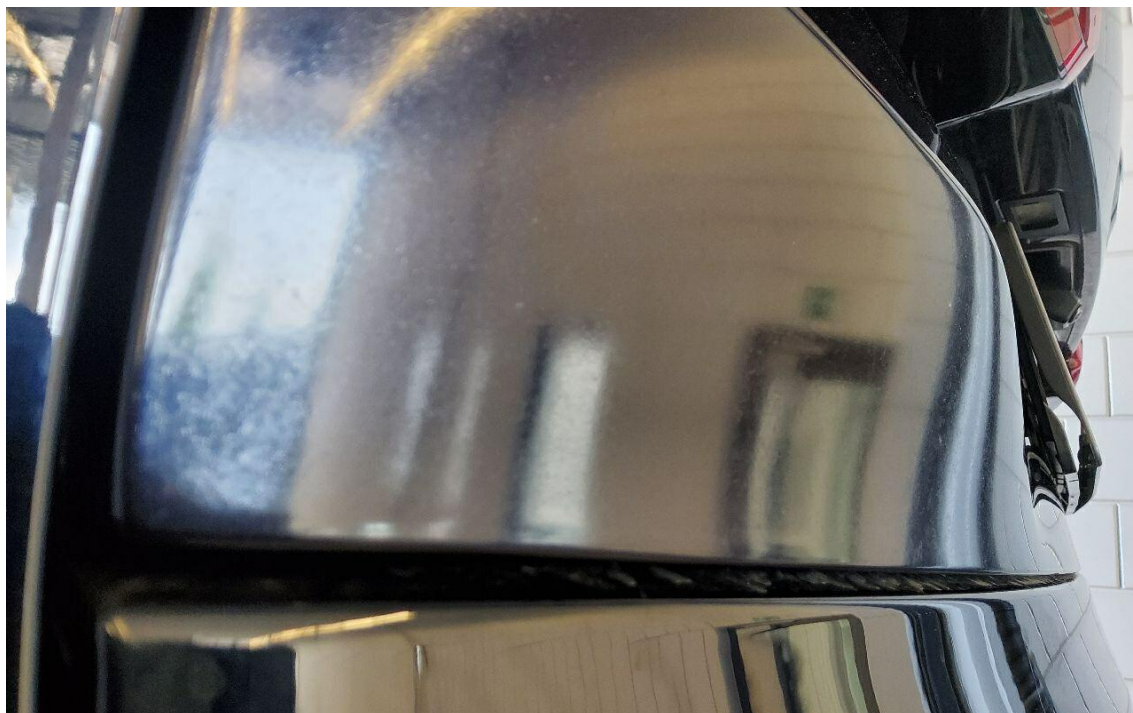
Bild 23 : Heckklappe deutliche Rep. Spuren sichtbar
