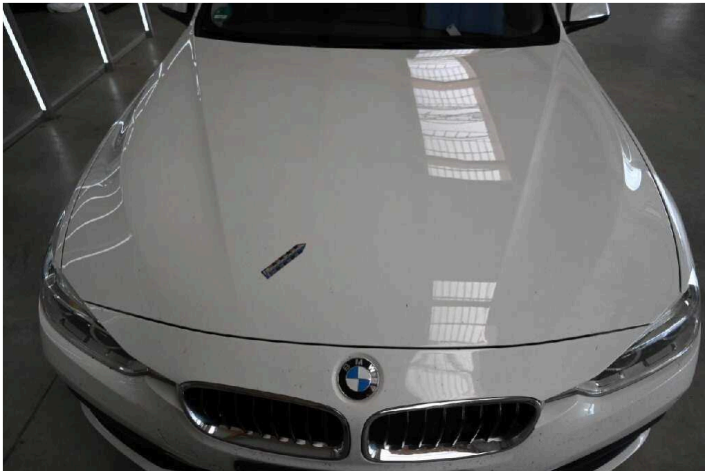
Bild 35 Fahrzeugfront Motorhaube Steinschlag / -schläge
