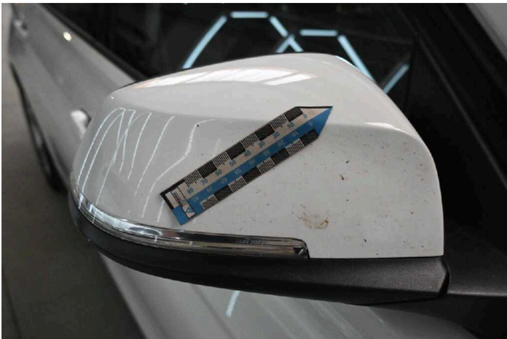
Bild 52 rechte Seite Außenspiegelgehäuse rechts Steinschlag / -schläge
