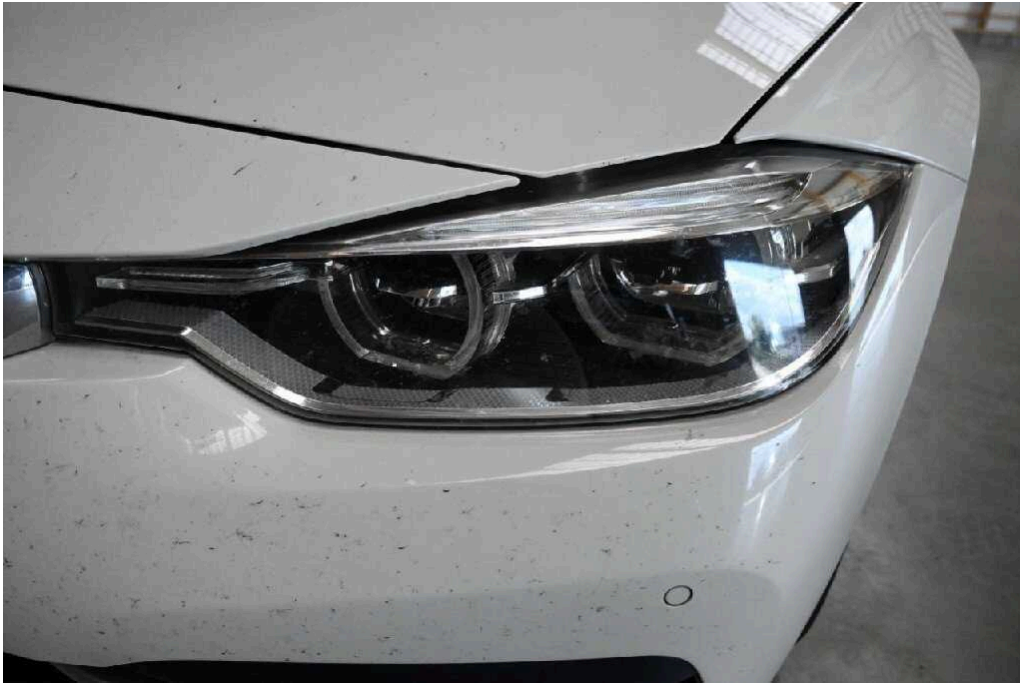
Bild 37 Fahrzeugfront Fahrzeug vorn Steinschlag / -schläge
