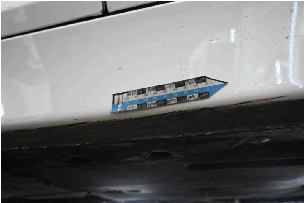
Bild 45 rechte Seite Schwellerverkleidung rechts verkratzt
