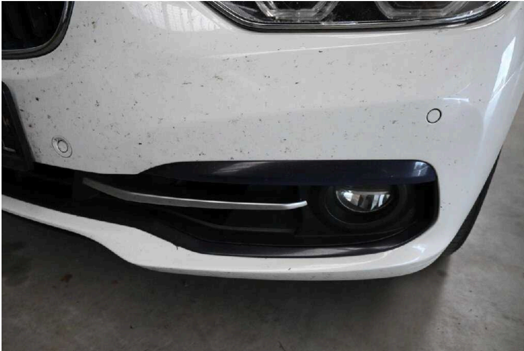
Bild 39 Fahrzeugfront Stoßfänger vorne verkratzt + Steinschlag / -schläge
