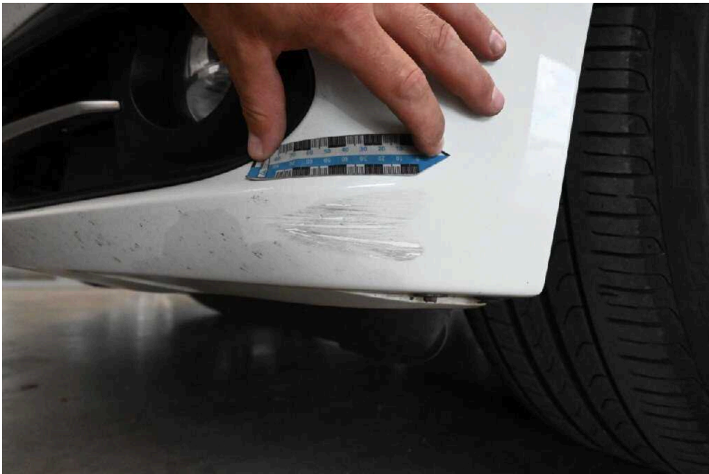
Bild 40 Fahrzeugfront Stoßfänger vorne verkratzt + Steinschlag / -schläge
