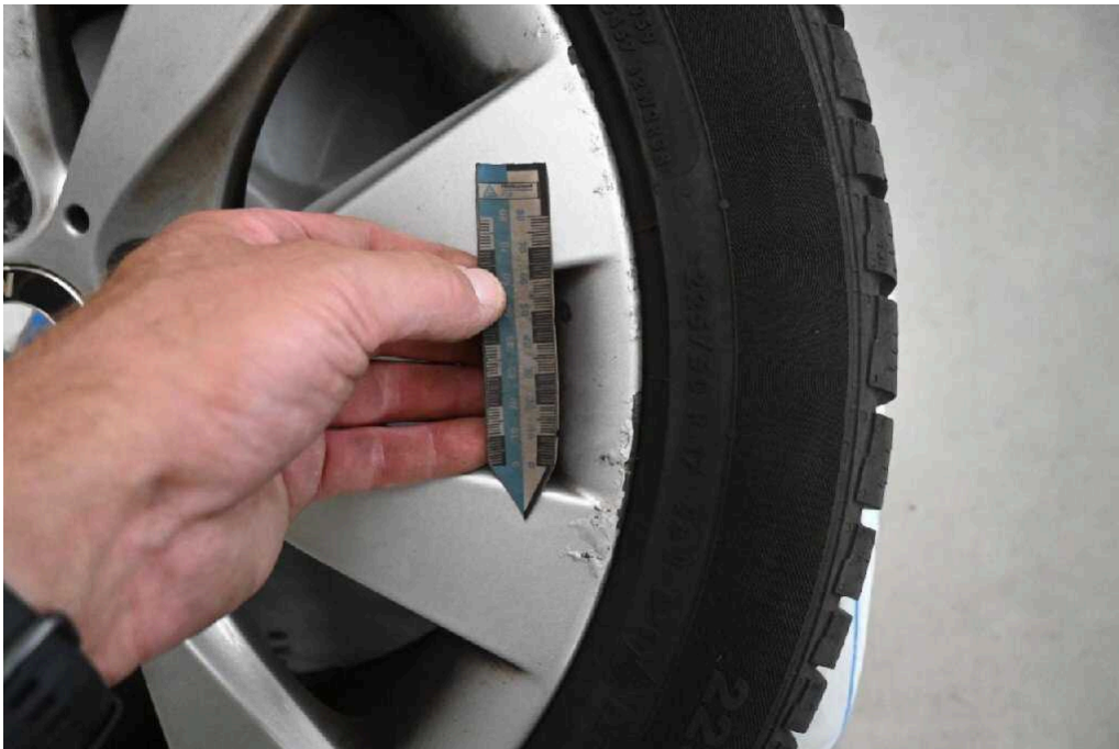
Bild 21 Fahrzeugzubehör 2. Reifensatz Rad 2 - Felge Lackabplatzer + korrodiert
