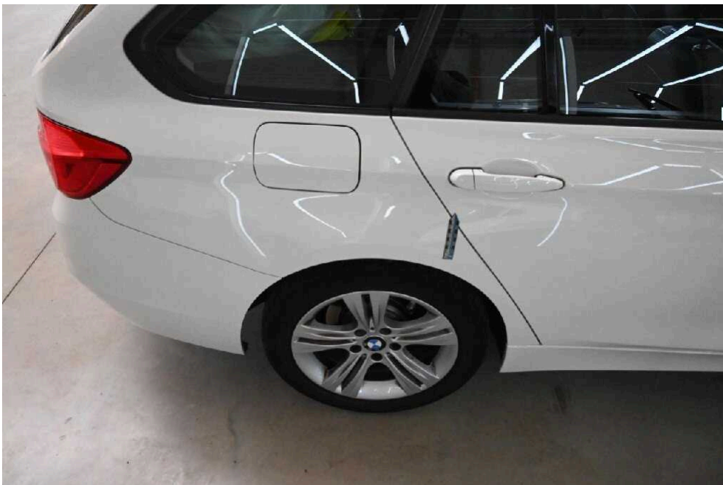
Bild 48 rechte Seite Seitenwand hinten rechts Kratzer -> Polieren + Delle
