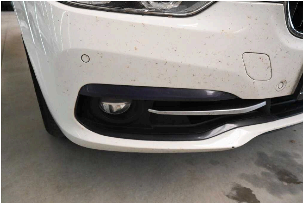
Bild 41 Fahrzeugfront Stoßfänger vorne verkratzt + Steinschlag / -schläge
