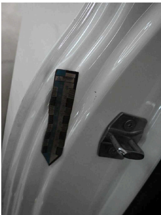
Bild 32 Innenraum Einstieg hinten rechts Kratzer
