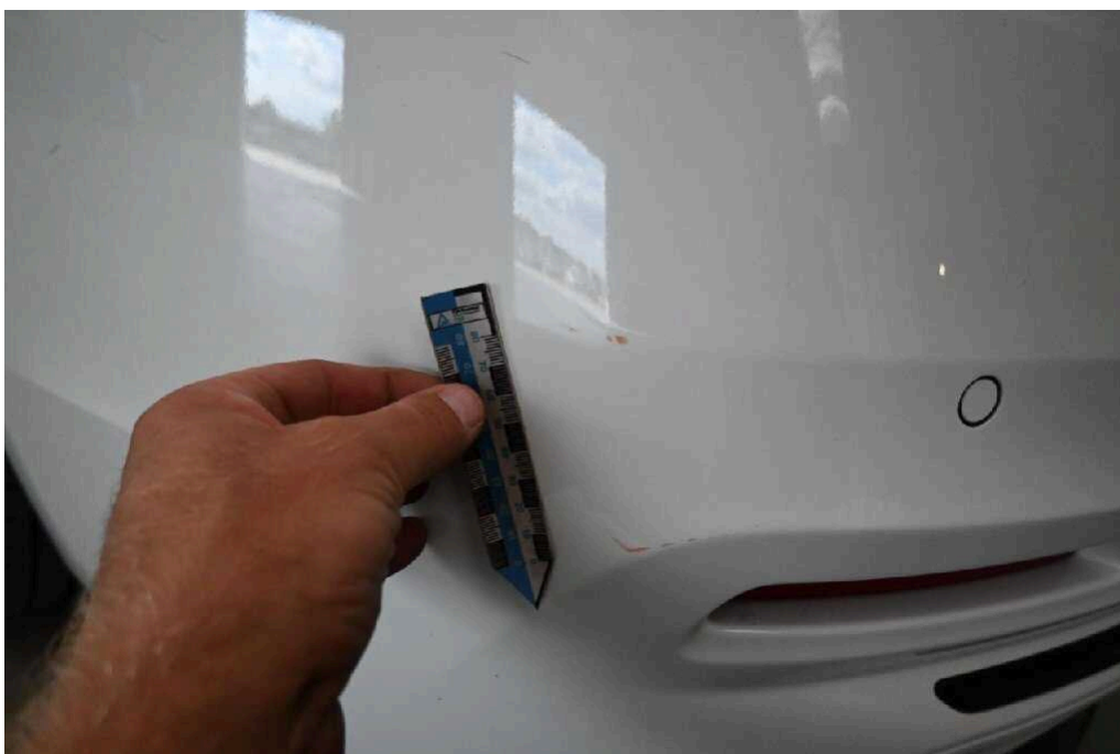
Bild 55 Fahrzeugheck Stoßfänger hinten verkratzt
