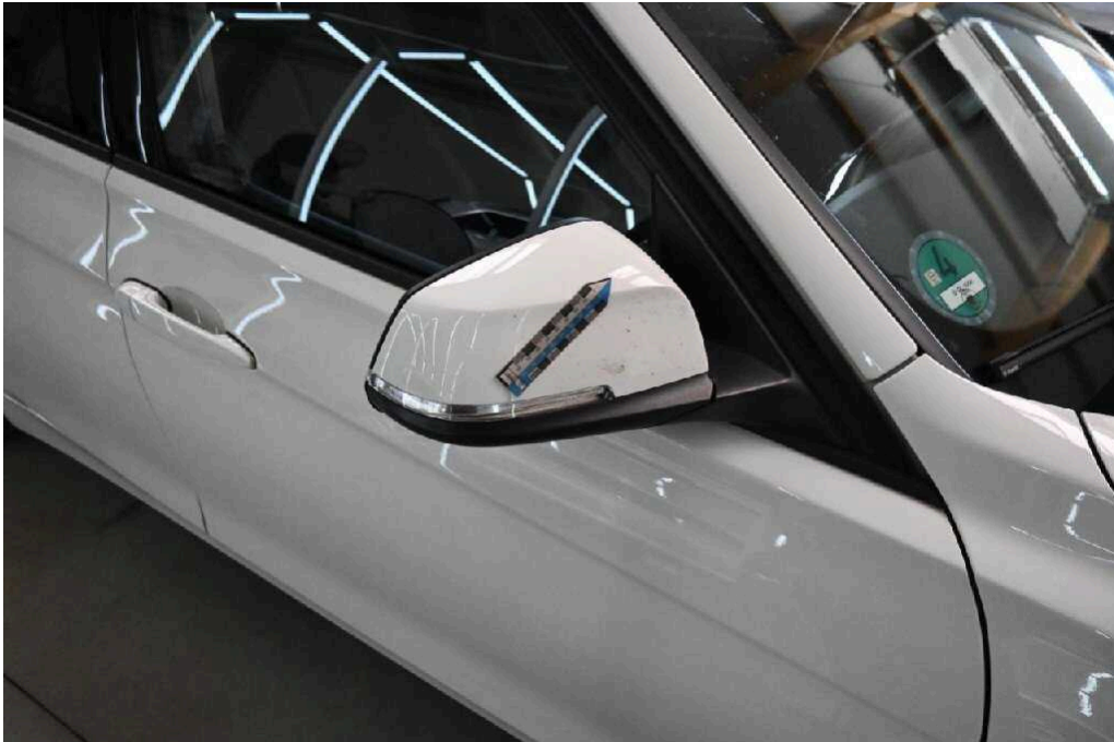
Bild 51 rechte Seite Außenspiegelgehäuse rechts Steinschlag / -schläge
