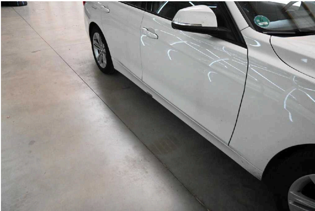
Bild 44 rechte Seite Schwellerverkleidung rechts verkratzt
