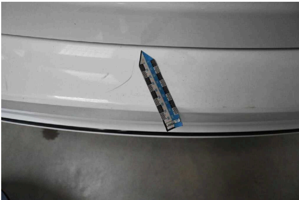
Bild 54 Fahrzeugheck Stoßfänger hinten verkratzt
