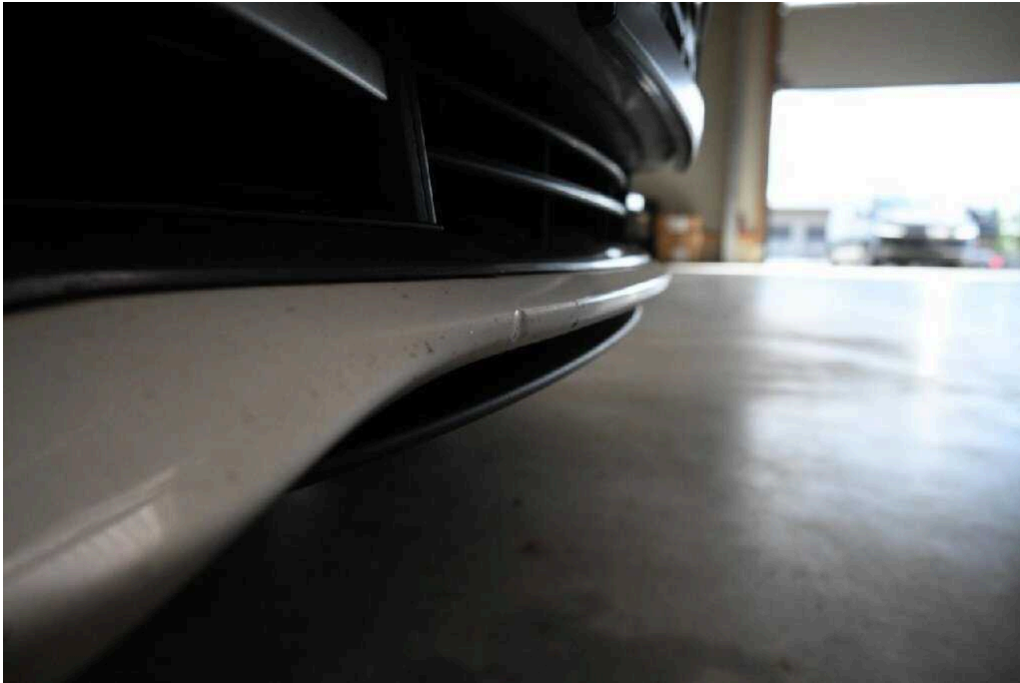
Bild 43 Fahrzeugfront Stoßfänger vorne verkratzt + Steinschlag / -schläge
