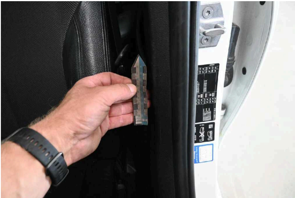
Bild 27 Innenraum Innenverkleidung B-Säule links Kratzer
