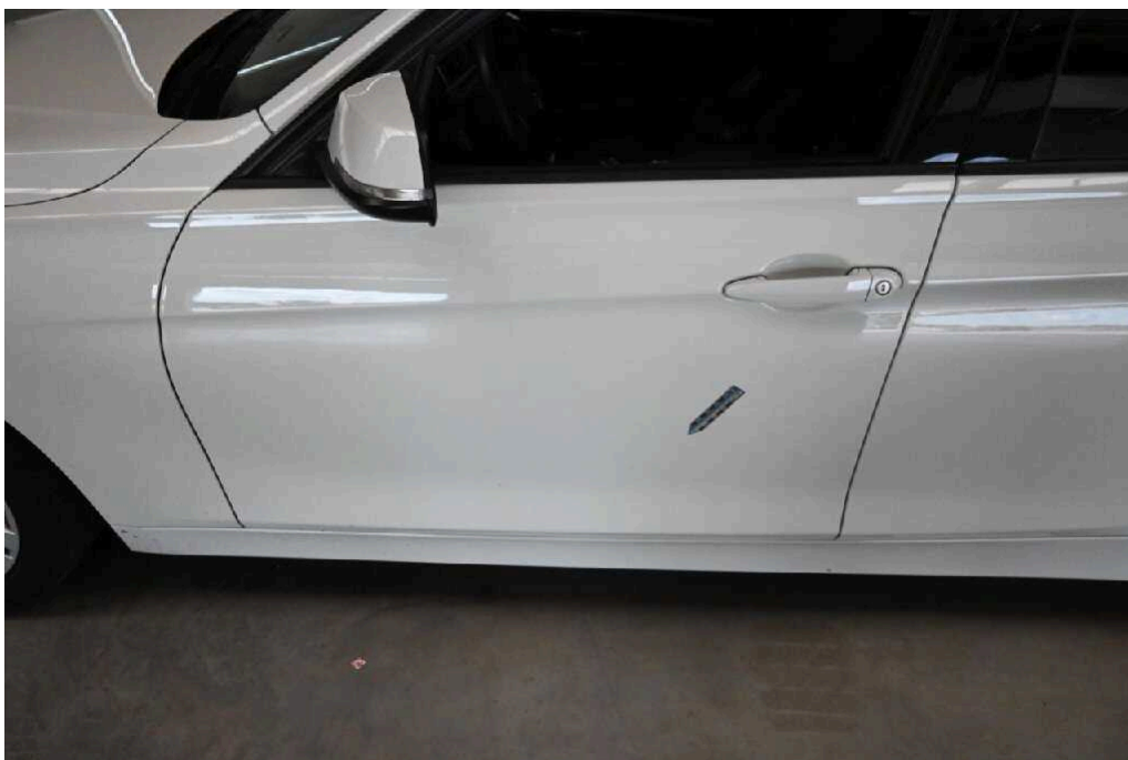
Bild 58 linke Seite Tür vorne links Delle
