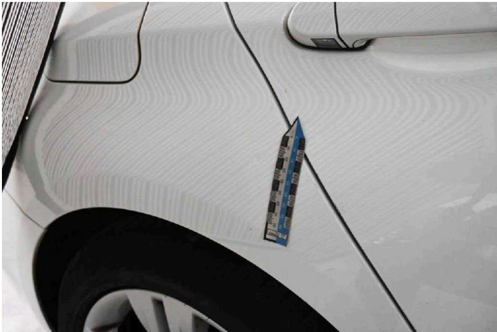
Bild 49 rechte Seite Seitenwand hinten rechts Kratzer -> Polieren + Delle
