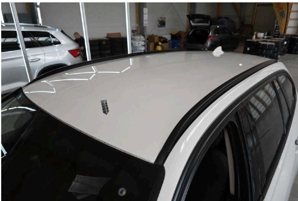
Bild 56 Dach Dachhaut Delle
