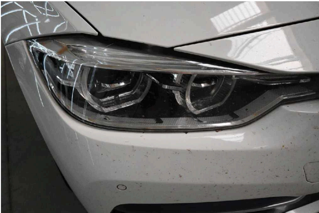
Bild 38 Fahrzeugfront Fahrzeug vorn Steinschlag / -schläge
