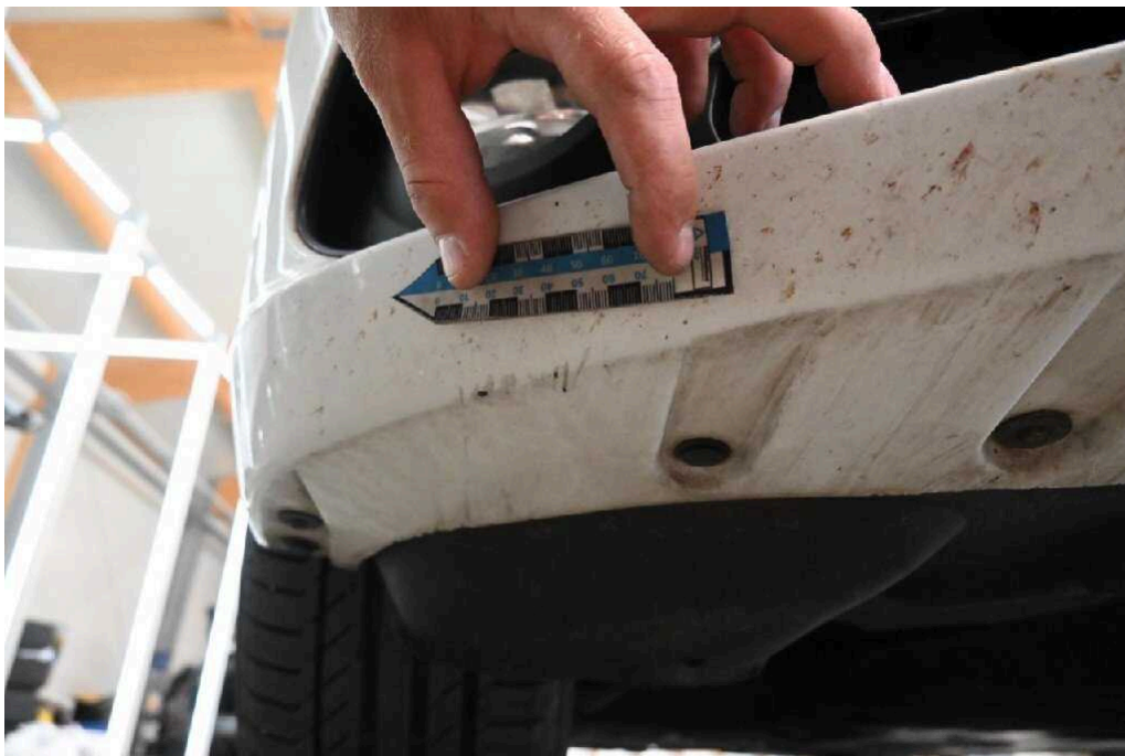
Bild 42 Fahrzeugfront Stoßfänger vorne verkratzt + Steinschlag / -schläge
