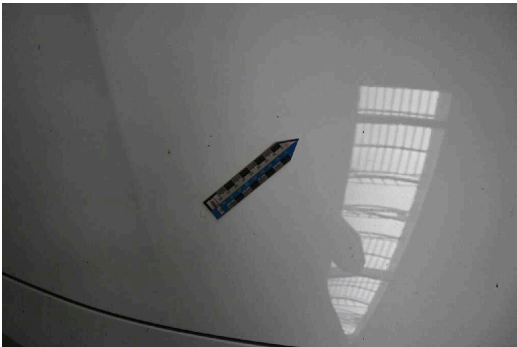
Bild 36 Fahrzeugfront Motorhaube Steinschlag / -schläge
