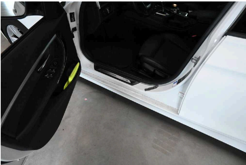
Bild 28 Innenraum Einstieg vorne links Kratzer + Delle
