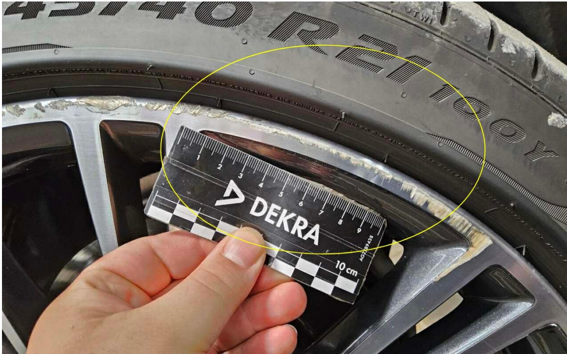
Bild 17 : Felge vorne rechts, verschrammt, smart repair
