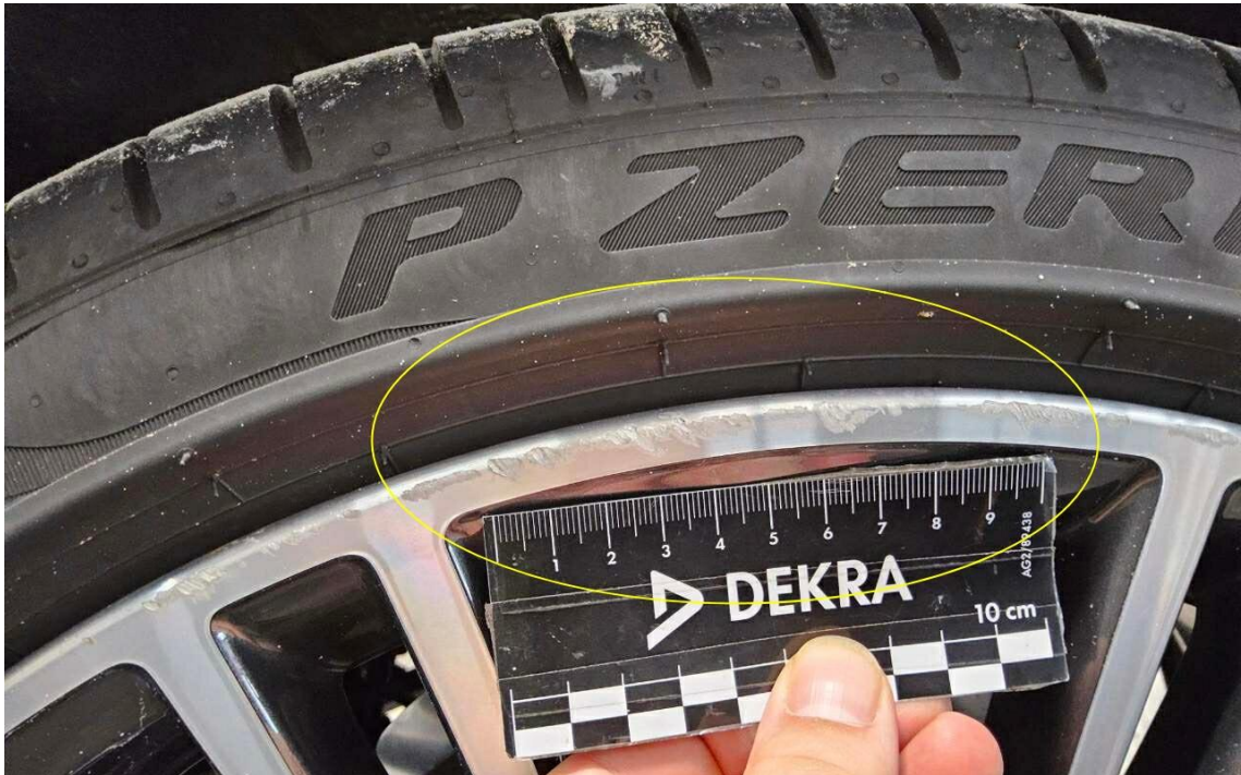
Bild 9 : Felge hinten links, verschrammt, smart repair
