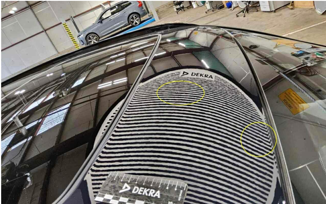
Bild 15 : Dach, eingedellt, smart repair
