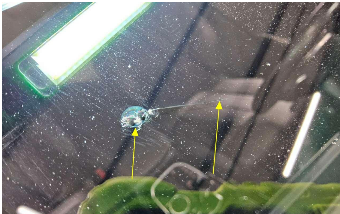
Bild 19 : Windschutzscheibe Steinschlag mit Rissbildung
