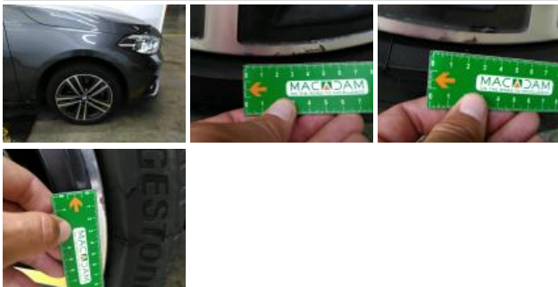
Pneu AVD, Déchirure, E - Remplacer
