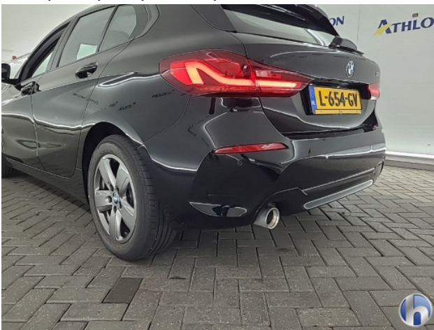
1. Achterbumper Schaafplek - Spot Repair/Deelreparatie
