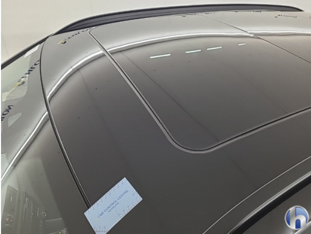
1. Dak Hagelschade - Herstellen zonder spuiten
