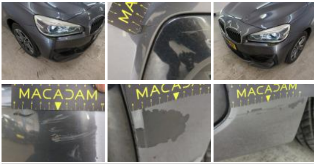
Grille de pare-chocs AVD, Griffe(s), E - Remplacer
