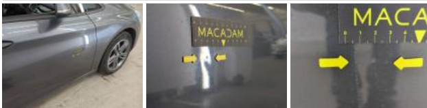
Coffre / hayon, Griffe(s), LI - Réparer et peindre (complet)
