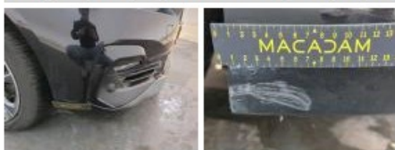
Grille, Gebroken, Vervangen
