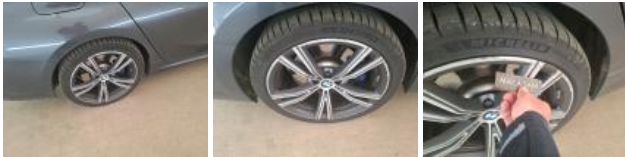
Jante alum. AVD bi-ton/polychrome, Déformé / Forcé, E - Remplacer
