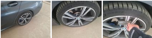
Jante alum. ARD bi-ton/polychrome, Griffe(s), Réparer/rempl. (montant forfaitaire)
