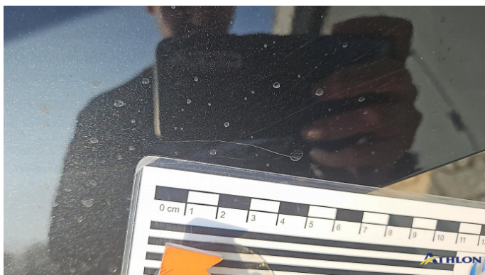
10. Heckklappe Kratzer Ab 60mm
