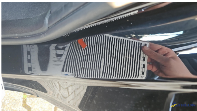
8. Türeinstieg Hinten - Links Verformt (leicht)
