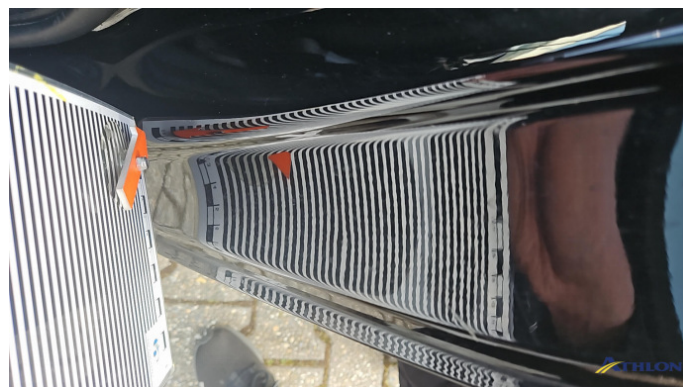
8. Türeinstieg Hinten - Links Verformt (leicht)
