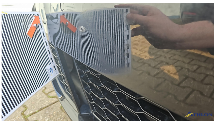
2. Stoßfänger Vorne Verformt (leicht)
