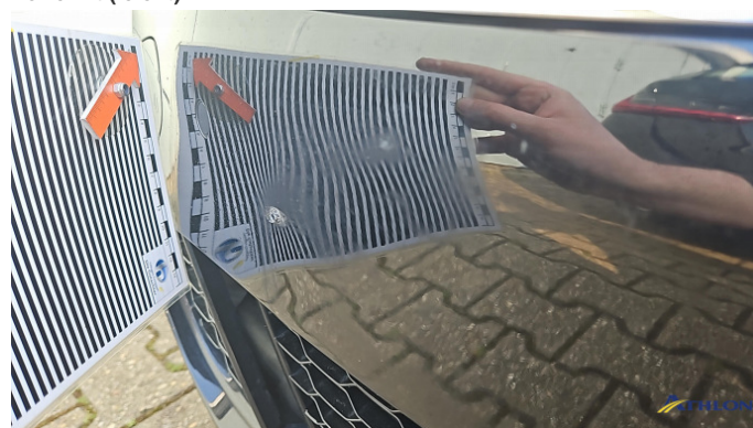
2. Stoßfänger Vorne Verformt (leicht)
