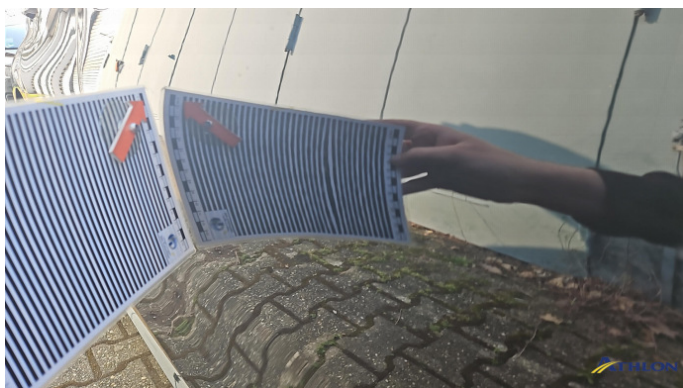
15. Tür Vorne - Rechts Verformt (leicht)
