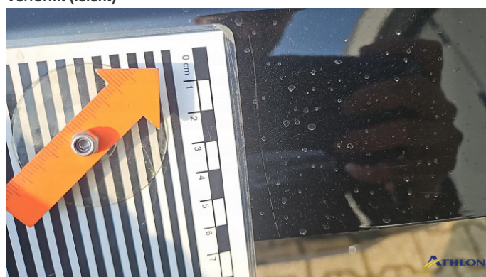
10. Heckklappe Kratzer Ab 60mm
