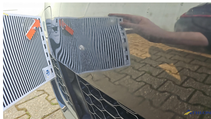
2. Stoßfänger Vorne Verformt (leicht)
