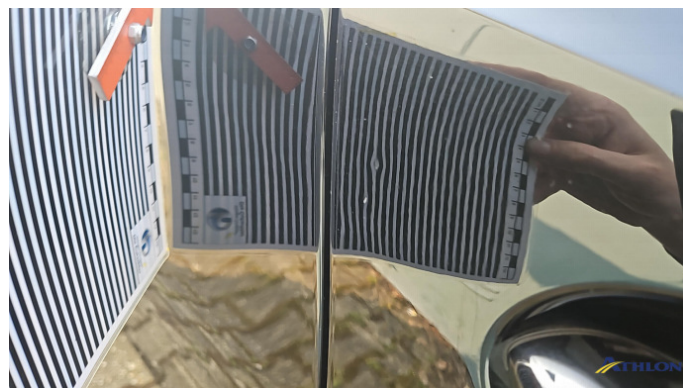
15. Tür Vorne - Rechts Verformt (leicht)
