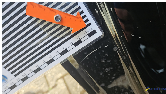
14. Türeinstieg Hinten - Rechts Kratzer
