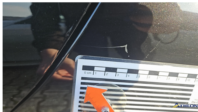
7. Seitenwand - Hinten - Links Kratzer
