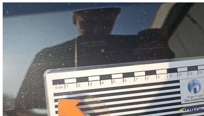
10. Heckklappe Kratzer Ab 60mm
