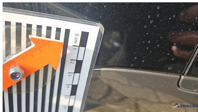
12. Stoßfänger Hinten Kratzer
