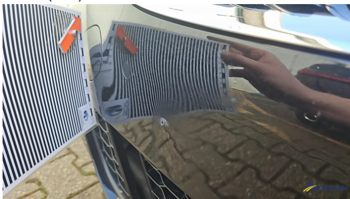
2. Stoßfänger Vorne Verformt (leicht)
