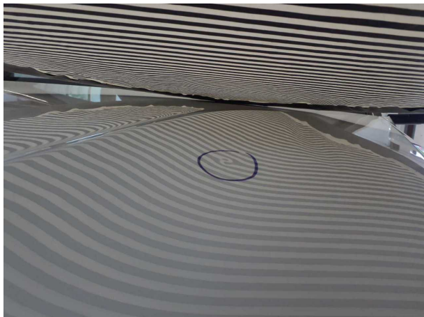
Beschädigung #6: Motorhaube: Motorhaube - Delle(n) - sanft instandsetzen
