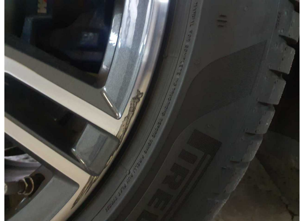
Beschädigung #9: Rad/Reifen: Leichtmetallfelge hinten rechts - verkratzt / verschürft - Wertminderung
