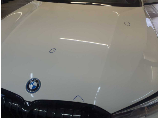
Beschädigung #1: Karosserie: Karosserie (+Steinschläge) - Kratzer - kein Abzug
