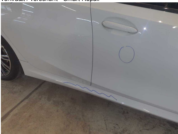
Beschädigung #12: Schweller rechts: Verkleidung - verkratzt / verschürft - instandsetzen und lackieren
