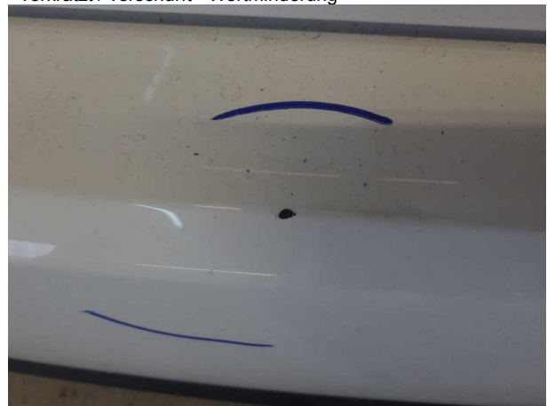
Beschädigung #10: Stossfänger hinten: Stossfänger hinten - verkratzt / verschürft - Smart Repair
