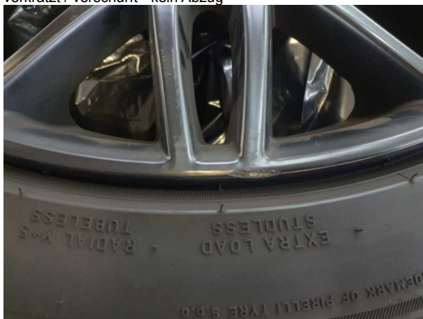
Beschädigung #3: 2.Radsatz: Leichtmetallfelgensatz komplett - verkratzt / verschürft - kein Abzug
