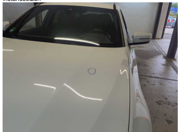
Beschädigung #6: Motorhaube: Motorhaube - Delle(n) - sanft instandsetzen
