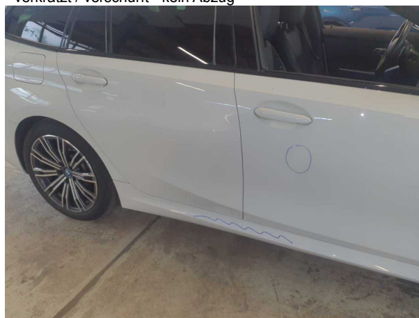
Beschädigung #4: Karosserie: Unterbodenverkleidung - beschädigt - erneuern
