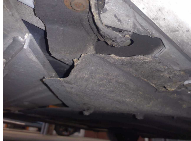
Beschädigung #4: Karosserie: Unterbodenverkleidung - beschädigt - erneuern
