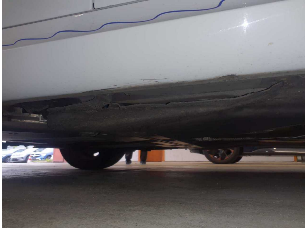
Beschädigung #4: Karosserie: Unterbodenverkleidung - beschädigt - erneuern
