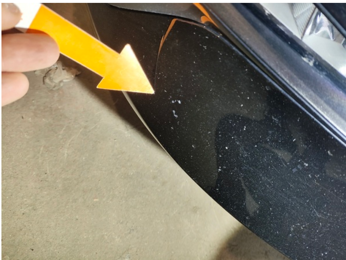
Stötfångare Fram Stenskott flertal 800 kr
