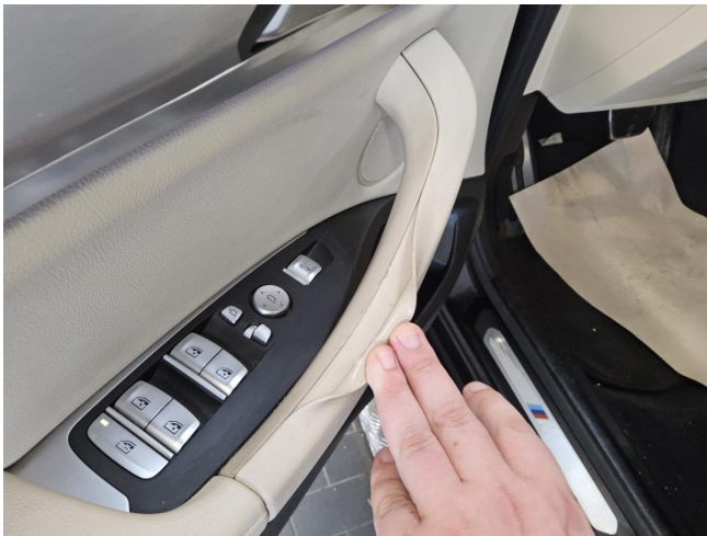
Türverkleidung VL stark beschädigt ern
