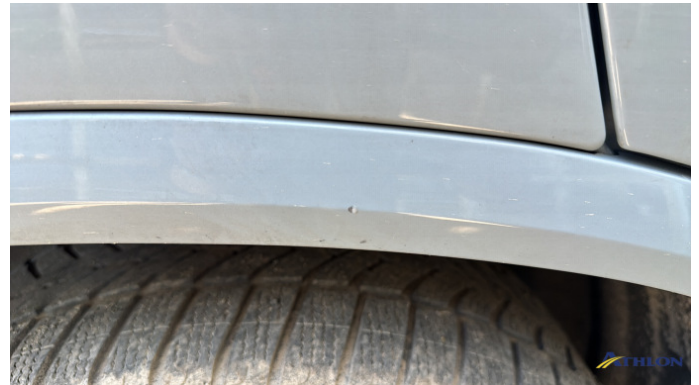
2. parete laterale - posteriore - destra Graffio/Rigature
