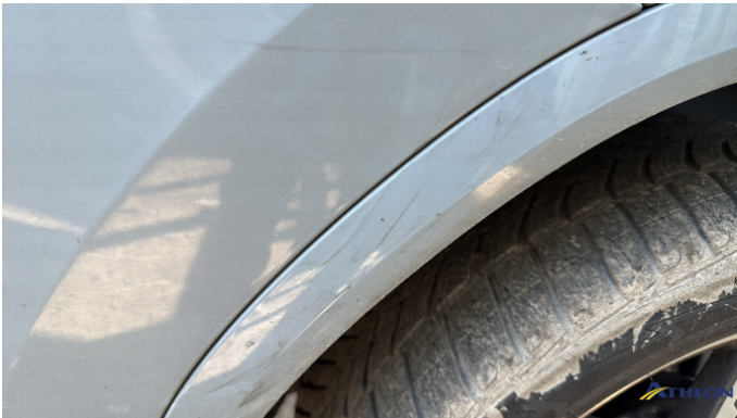
2. parete laterale - posteriore - destra Graffio/Rigature
