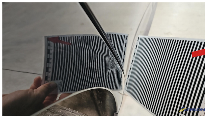
10. Seitenwand - Hinten - Rechts Verformt (leicht)
