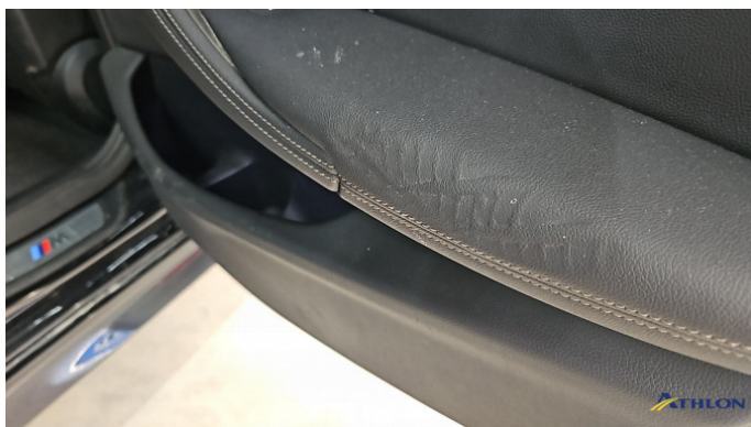
13. Türverkleidung Hinten - Rechts Verformt (leicht)
