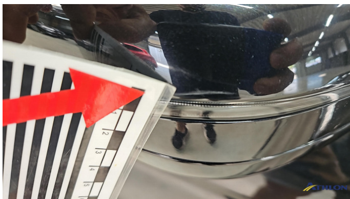
11. Außenspiegel Gehäuse - Rechts Kratzer
