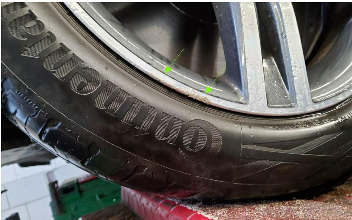
Bild 16 : Alufelge (Sommer) glanzgedreht vorne links verschrammt
