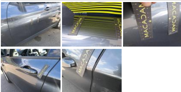
Door trim FL, Scratch(es), Acceptable
