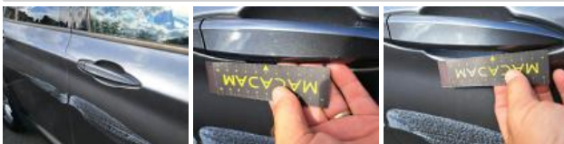
Sill trim R, Scratch(es), Replace
