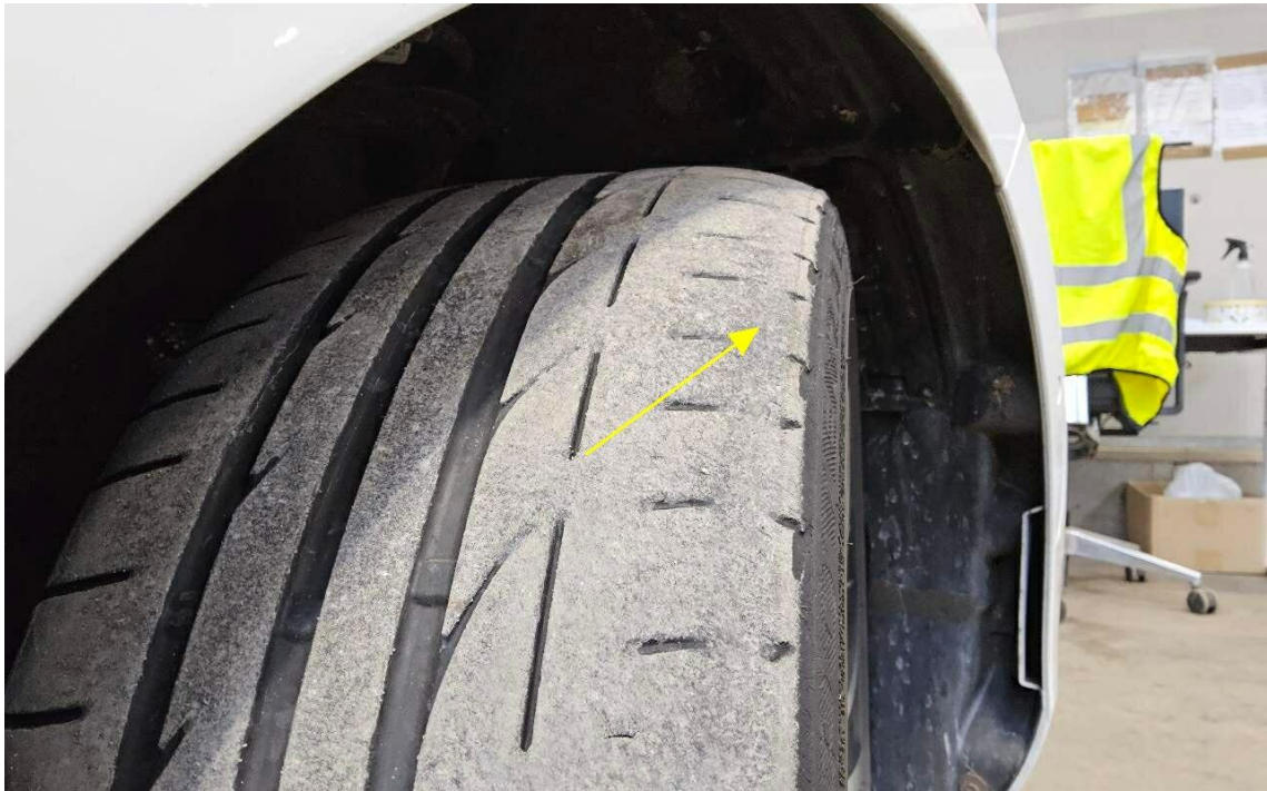
Bild 15 : Reifen vorne ungleichmäßig abgefahren, Achsvermessung
