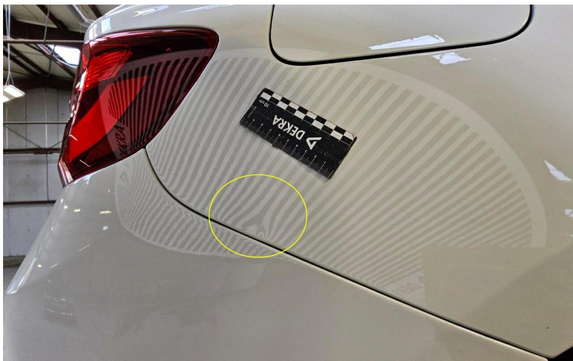
Bild 10 : Seitenteil hinten rechts, eingedellt, smart repair
