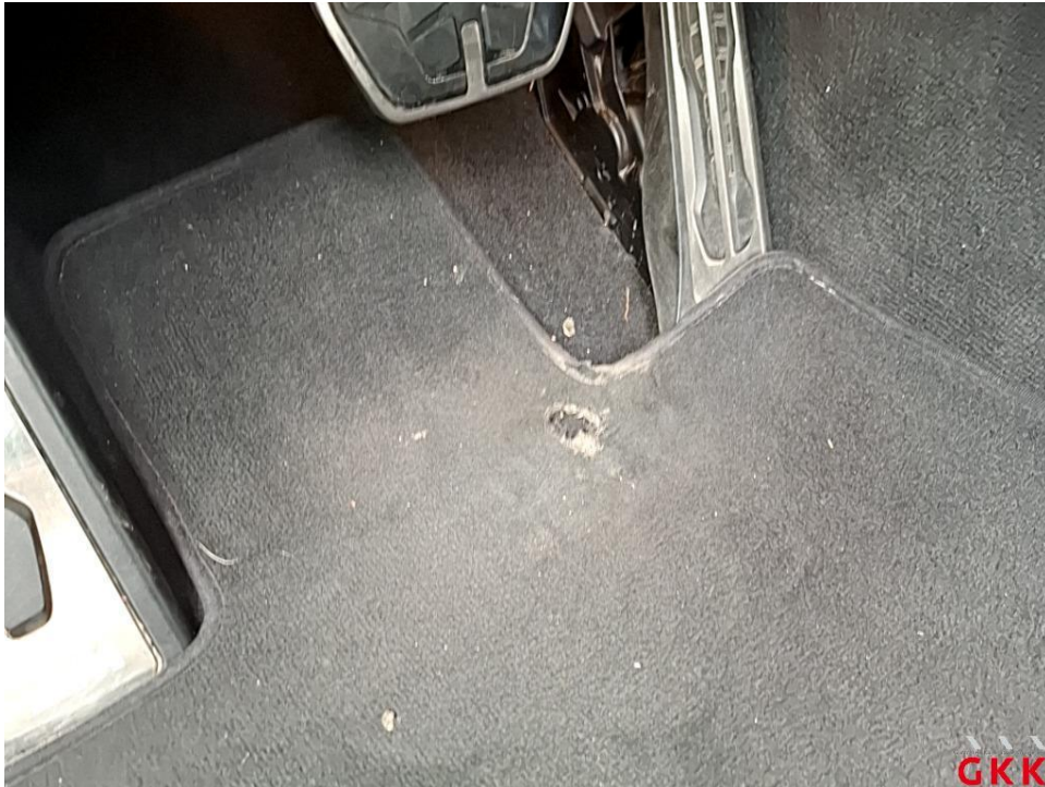
Bild 19. Fußmatte(n), vorne links, beschädigt, ersetzen
