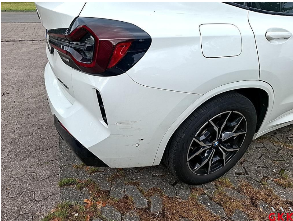
Bild 22. Stoßfänger hinten, Verkleidung oberhalb -lackiert-, verkratzt, instand setzen - lackieren
