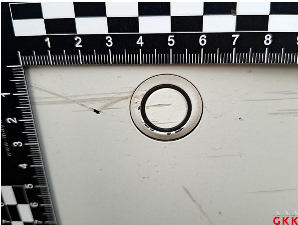
Bild 26. Stoßfänger hinten, PDC-Sensor, verkratzt, ersetzen
