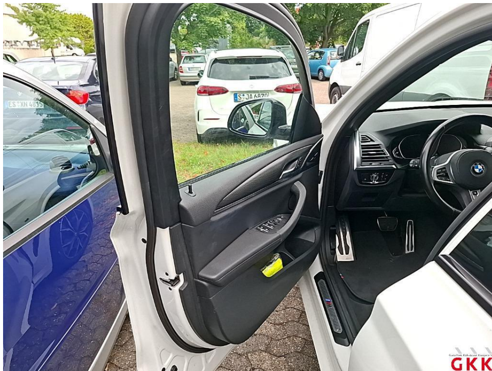
Bild 30. Tür vorne links, Innenverkleidung -Standard-, verkratzt, ersetzen
