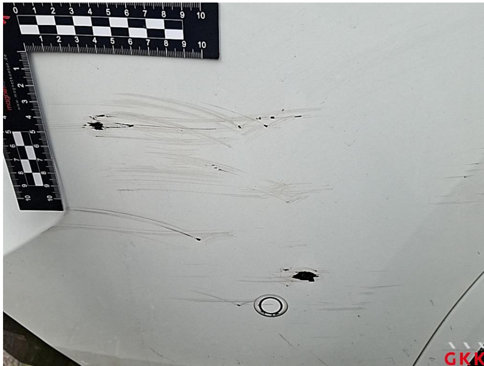
Bild 23. Stoßfänger hinten, Verkleidung oberhalb -lackiert-, verkratzt, instand setzen - lackieren
