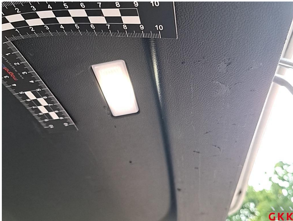
Bild 29. Heckklappe, Innenverkleidung, verkratzt, ersetzen
