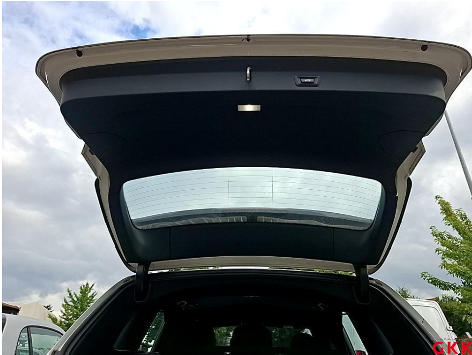
Bild 27. Heckklappe, Innenverkleidung, verkratzt, ersetzen
