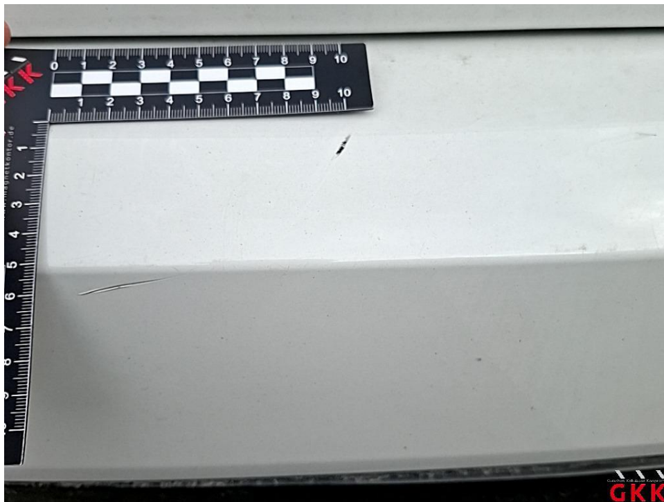
Bild 24. Stoßfänger hinten, Verkleidung oberhalb -lackiert-, verkratzt, instand setzen - lackieren
