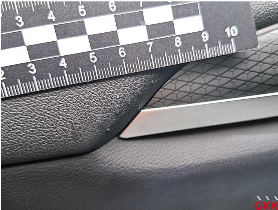
Bild 31. Tür vorne links, Innenverkleidung -Standard-, verkratzt, ersetzen
