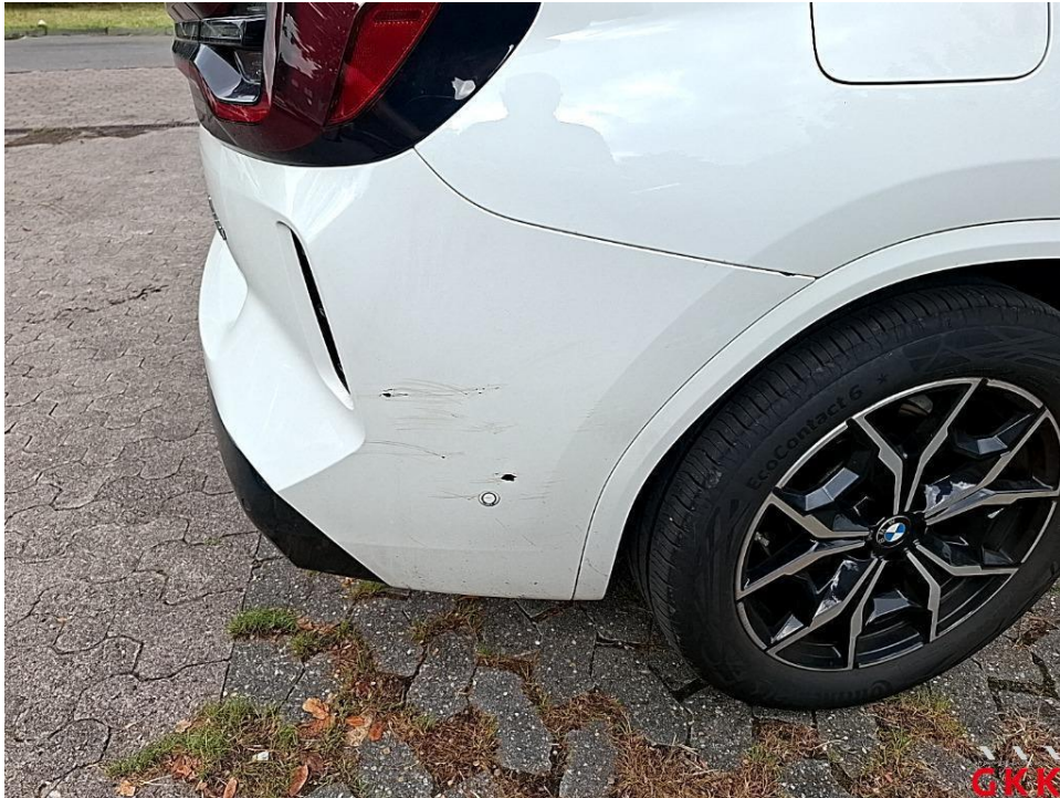
Bild 25. Stoßfänger hinten, PDC-Sensor, verkratzt, ersetzen
