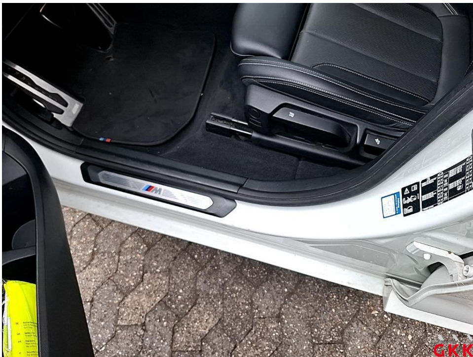
Bild 16. Tür vorne links, Einstieg, verkratzt, auslegen, schleifen, polieren
