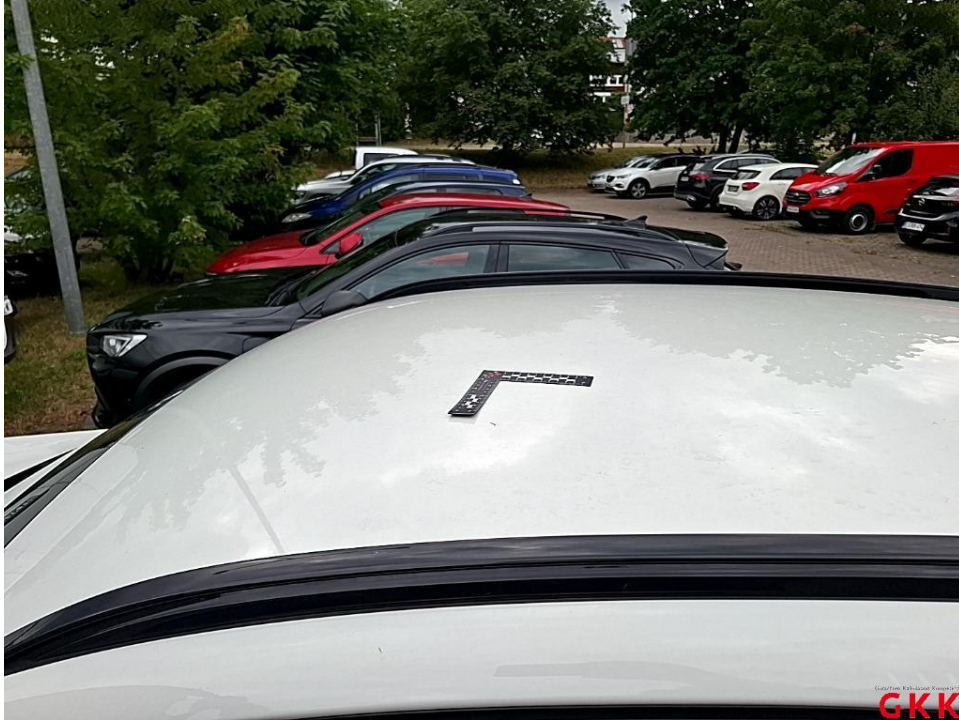
Bild 13. Dach, bis 3 Dellen / Bauteil, kalt drücken
