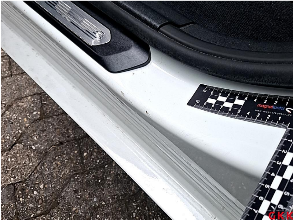
Bild 17. Tür vorne links, Einstieg, verkratzt, auslegen, schleifen, polieren
