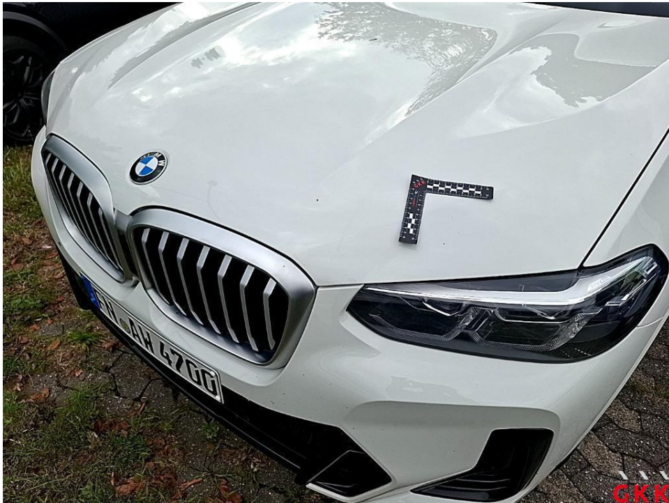
Bild 20. Motorhaube, Steinschlag, lackieren
