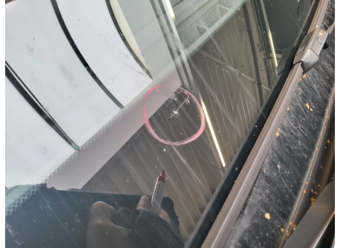
Windschutzscheibe - Steinschlag mit Rissbildung, ersetzen
