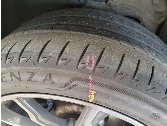
Reifen (Sommer-Radsatz) - Hinterachse links - Fremdkörper in Lauffläche, erneuern
