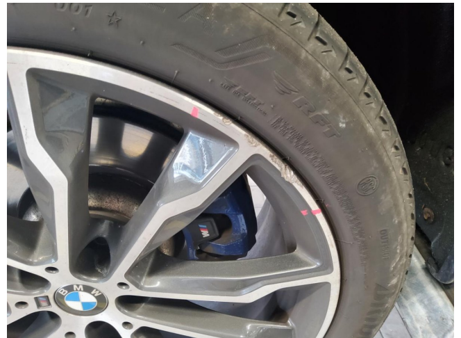
Felge (Sommer-Radsatz) - Hinterachse rechts - beschädigt, erneuern
