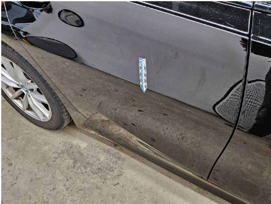
Bild 29 rechte Seite Tür hinten rechts Kratzer
