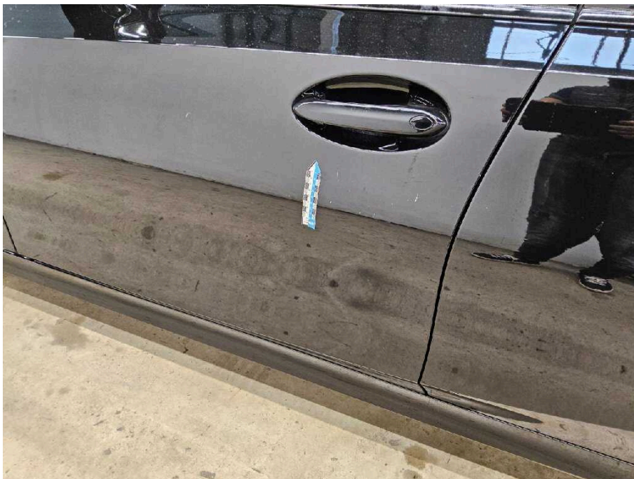
Bild 38 linke Seite Tür vorne links Kratzer
