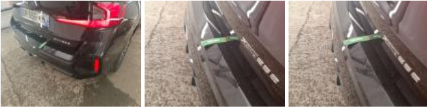
Pare-chocs AR, Déformé / Forcé, LI - Réparer et peindre (complet)
