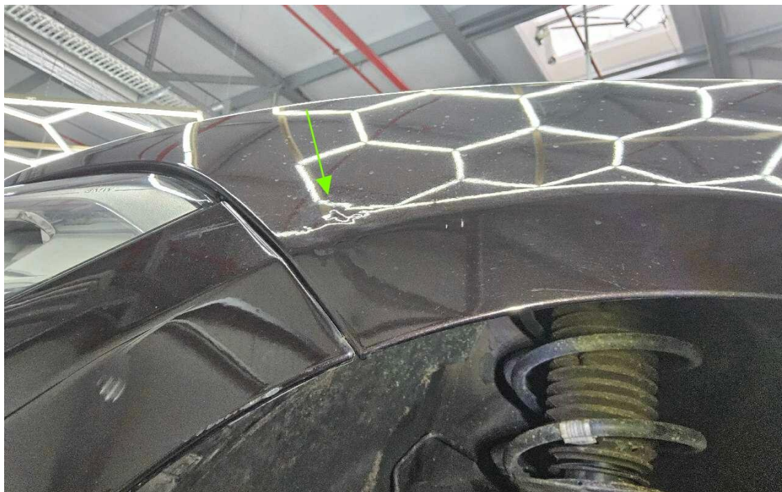
Bild 15 : Korrosionsbildung Kotflügel vorne links
