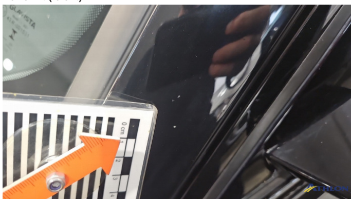
2. A-Säule Vorne - Links Steinschlag
