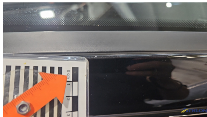
5. A-Säule Vorne - Rechts Steinschlag
