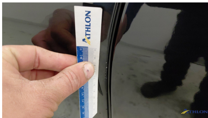
3. B-colonna centrale - sinistra Scheggiatura
