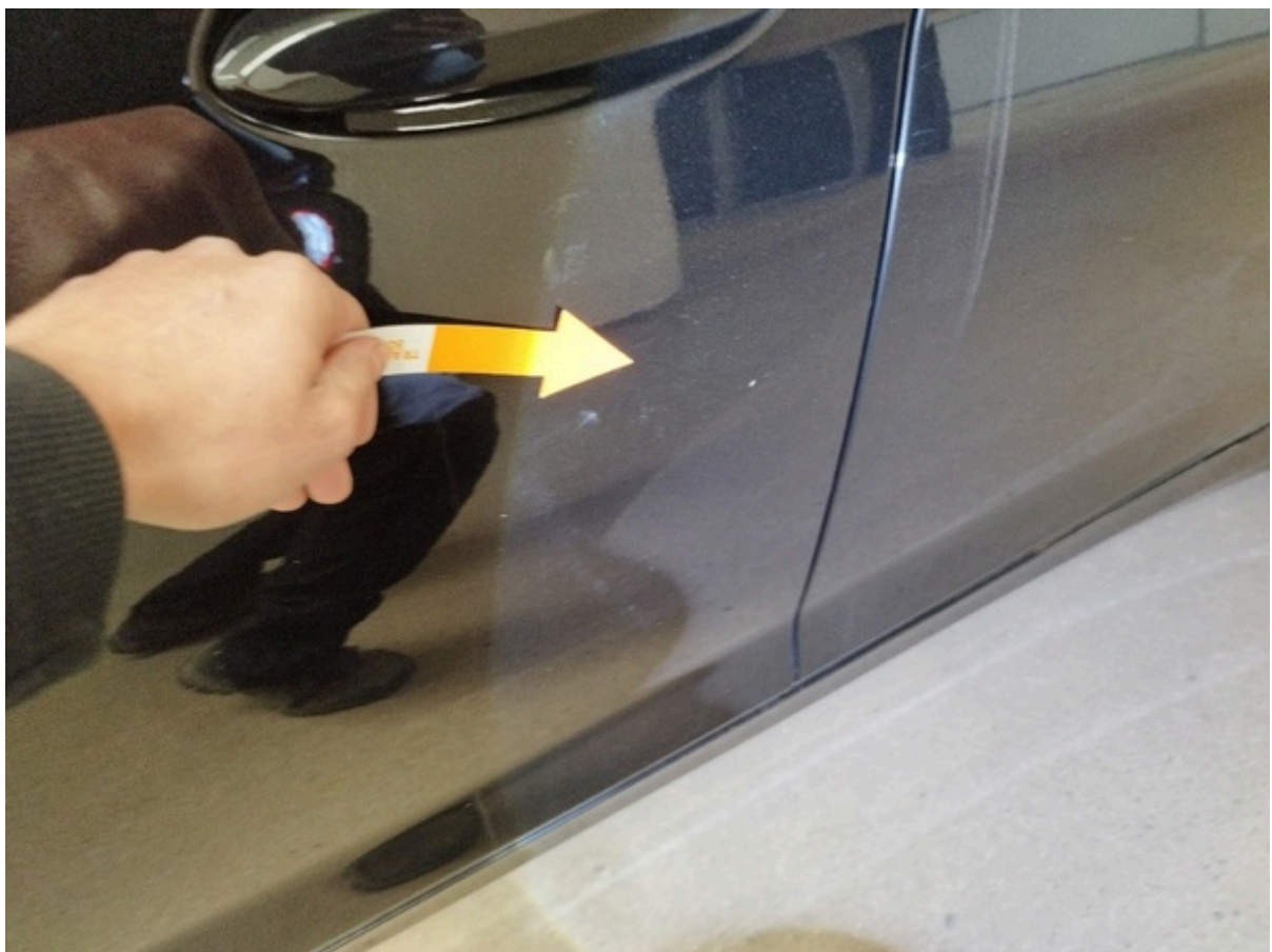
Dörr Vänster fram Lackskador
