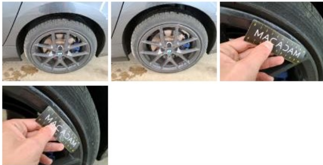
Pneu ARG, Déchirure, E - Remplacer
