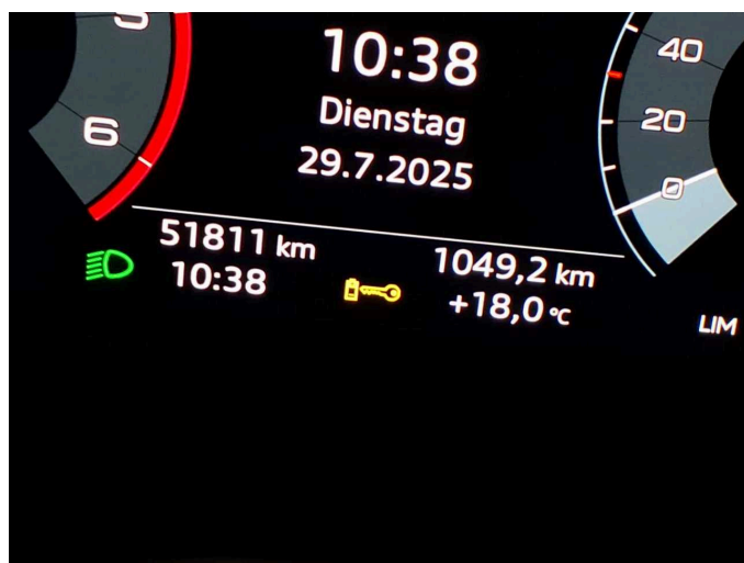
Beschädigung 1: Ausrüstung: Fahrzeugschlüssel (Batterie) - leer - erneuern
