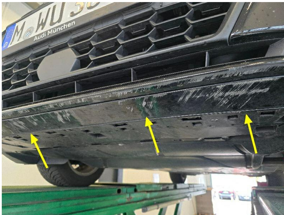
Bild 17 : Stoßfänger vorne Lackierung, zerkratzt, lackieren mit Lackaufbau
