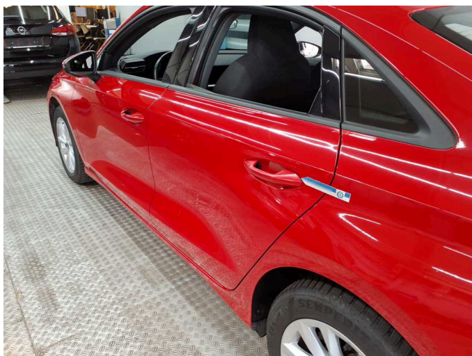
Beschädigung 4: Tür hinten links: Griff außen - Lackmangel - lackieren
