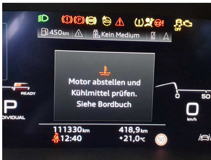
Beschädigung 2: Motorkühlung: Kühflüssigkeit (Keine Flüssigkeit im Behälter) - fehlt - Diagnose durchführen
