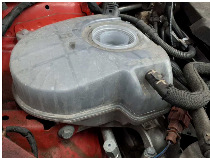
Beschädigung 2: Motorkühlung: Kühlflüssigkeit (Keine Flüssigkeit im Behälter) - fehlt - Diagnose durchführen
