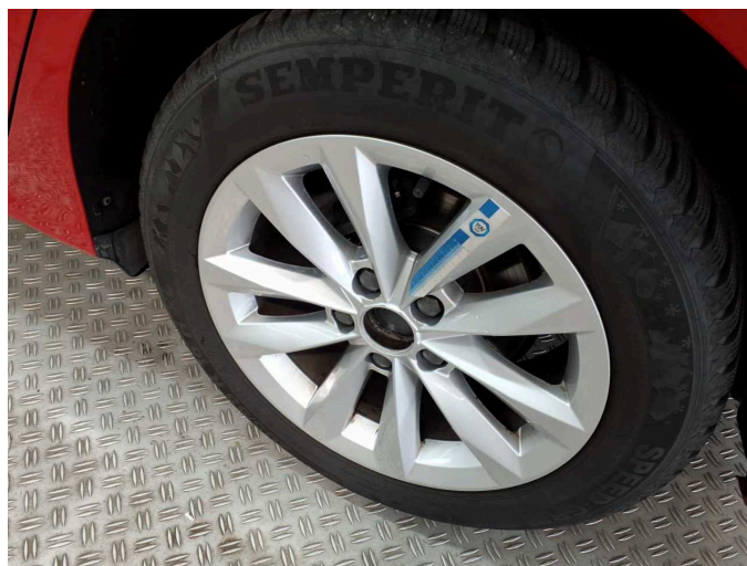
Beschädigung 1: Hinterachse: Radnabe links (Deckel) - fehlt - erneuern
