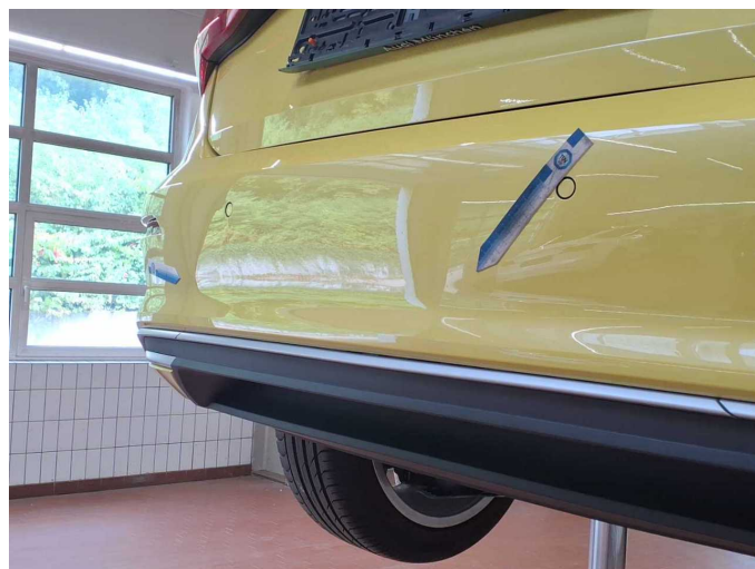
Beschädigung 7: Stossfänger hinten: Stossfänger mit Parktronic (Verformt) - verformt - instandsetzen und lackieren
