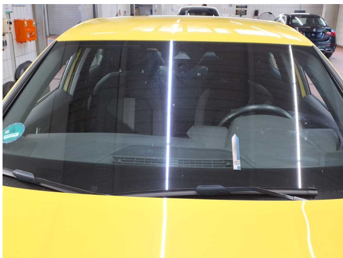
Beschädigung 8: Verglasung: Frontscheibe (Sichtbereich) - Steinschlag - erneuern
