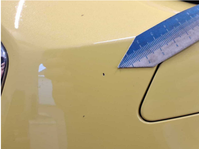
Beschädigung 6: Stossfänger vorn: Stossfänger vorn - Steinschlag - lackieren
