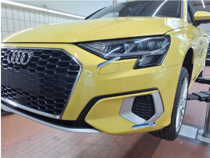
Beschädigung 6: Stossfänger vorn: Stossfänger vorn - Steinschlag - lackieren
