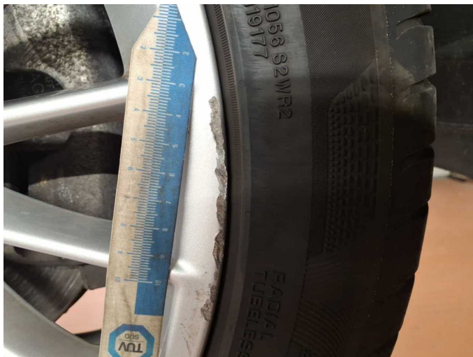
Beschädigung 5: Rad/Reifen: Leichtmetallfelge vorn rechts (Materialabtrag) - verkratzt / verschürft - erneuern
