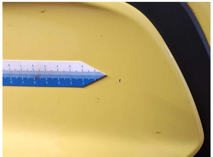
Beschädigung 6: Stossfänger vorn: Stossfänger vorn - Steinschlag - lackieren
