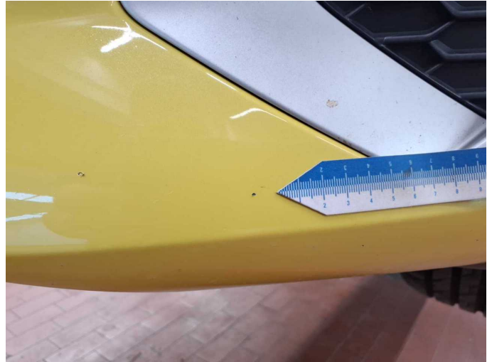
Beschädigung 6: Stossfänger vorn: Stossfänger vorn - Steinschlag - lackieren
