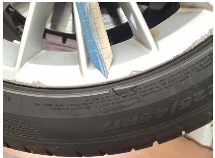
Beschädigung 4: Rad/Reifen: Reifen vorn rechts - beschädigt - erneuern
