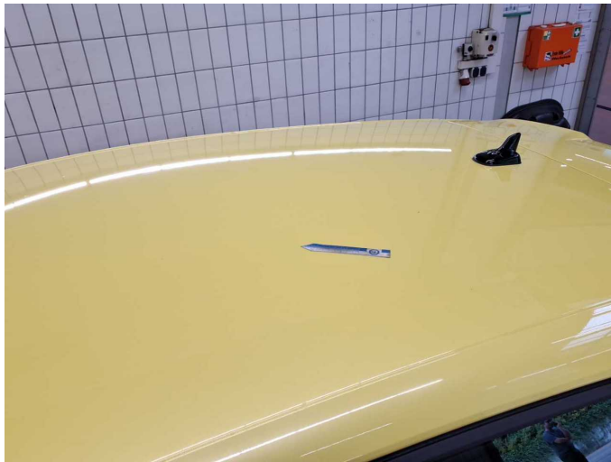
Beschädigung 2: Fahrzeugdach: Dach - Delle(n) - Smart Repair
