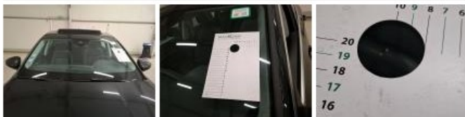
Pare-brise, Eclat(s), E - Remplacer
