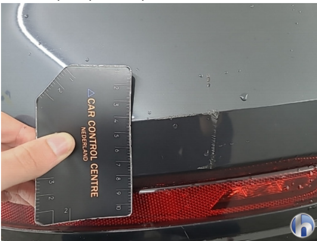
2. Achterbumper Krassen - Spot Repair/Deelreparatie
