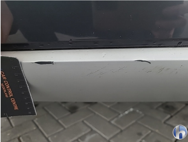
2. Achterbumper Krassen - Spot Repair/Deelreparatie
