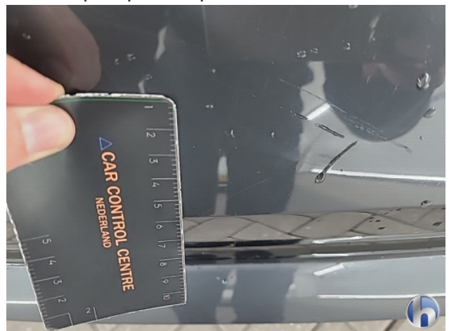
2. Achterbumper Krassen - Spot Repair/Deelreparatie
