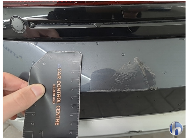
2. Achterbumper Krassen - Spot Repair/Deelreparatie
