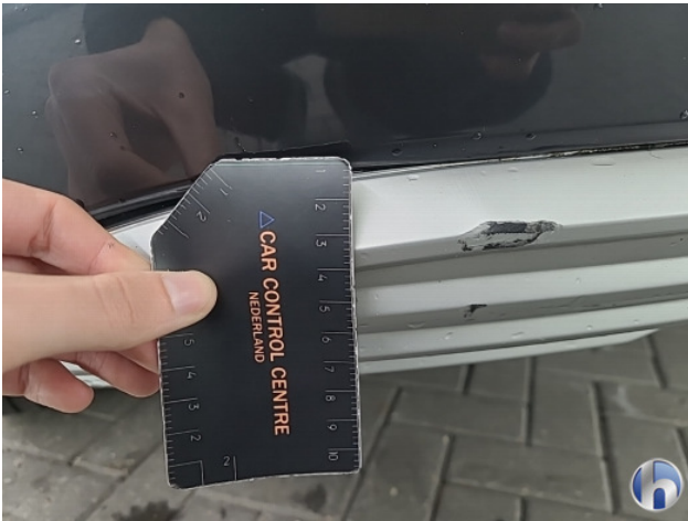
2. Achterbumper Krassen - Spot Repair/Deelreparatie
