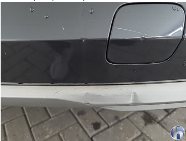
2. Achterbumper Krassen - Spot Repair/Deelreparatie
