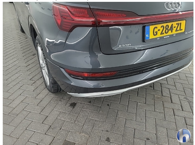
2. Achterbumper Krassen - Spot Repair/Deelreparatie
