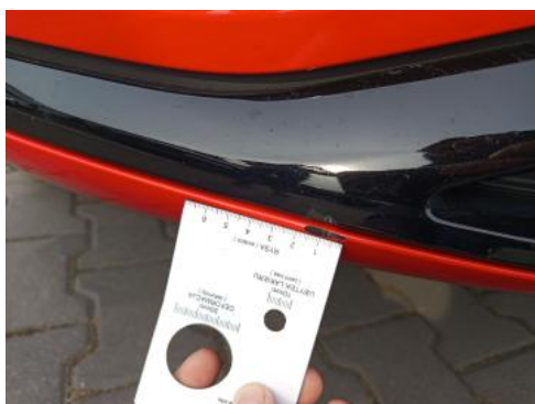
Fot. 43 Zderzak - Rysa/odprysk 1
