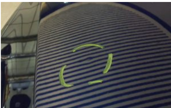
Gebrauchsspur 1: Motorhaube: Motorhaube - Delle(n) - kein Abzug
