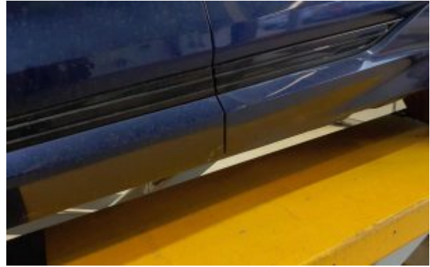
Beschädigung 3: Tür vorn links: Tür - verkratzt / verschürft - Smart Repair
