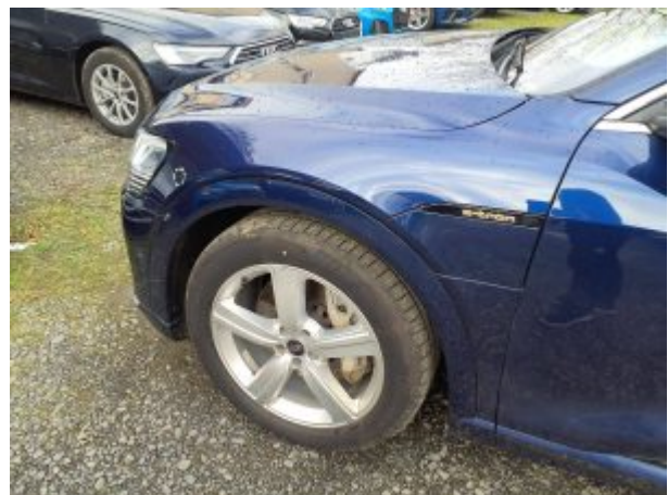
Beschädigung 2: Kotflügel links: Kotflügel links - verkratzt / verschürft - Smart Repair
