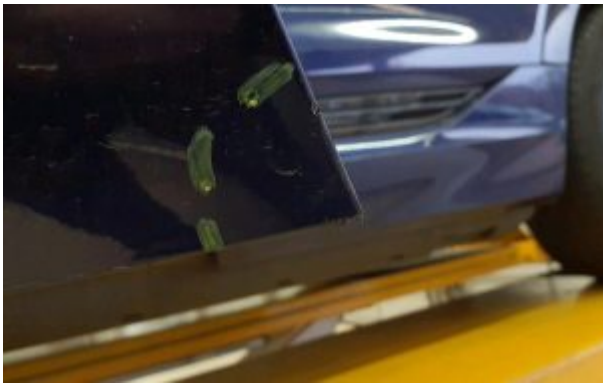
Beschädigung 3: Tür vorn links: Tür - verkratzt / verschürft - Smart Repair
