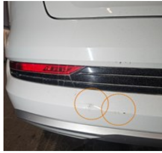
7.4.2 - Stötfångare bak Skrap och lackskador
