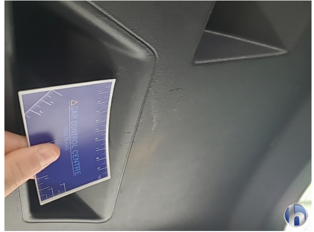
2. kofferdekselbekleding Gebruikssporen - Aanvaardbaar
