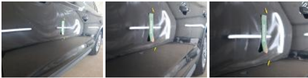
Porte ARG, Mauvaise réparation, Peindre
