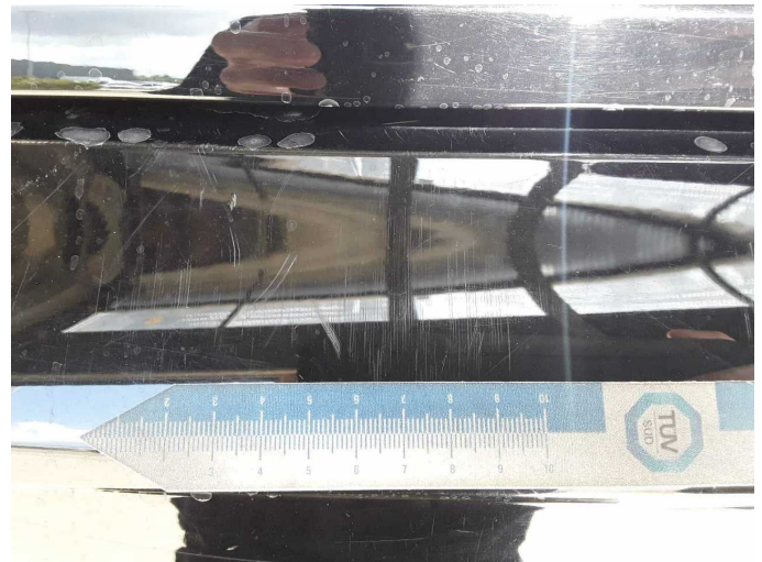
Damage 1: Rear bumper: Rear bumper (ist bereits im Unfallschaden berücksichtigt) - Scratch(es) - No deduction
