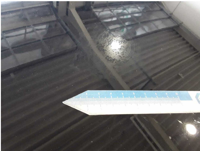
Damage 5: Bonnet: Bonnet (Verätzungen) - Paint defect - Paint
