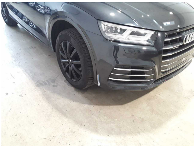
Beschädigung 2: Kotflügel rechts: Radhausverbreiterung - Fehlstellung - de-/montieren
