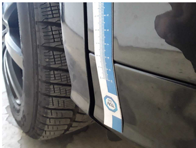
Beschädigung 2: Kotflügel rechts: Radhausverbreiterung - Fehlstellung - de-/montieren
