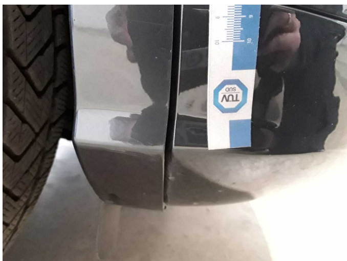
Beschädigung 2: Kotflügel rechts: Radhausverbreiterung - Fehlstellung - de-/montieren
