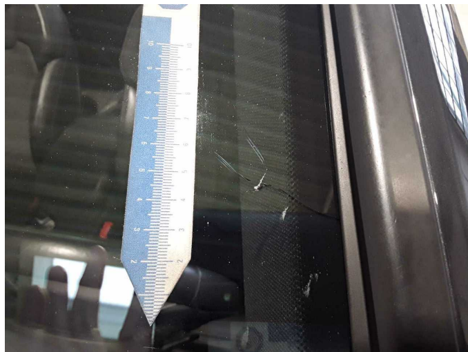
Beschädigung 6: Verglasung: Frontscheibe - beschädigt - erneuern
