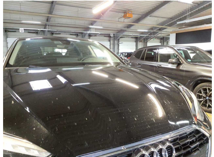
Damage 5: Bonnet: Bonnet (Sandstrahleffekt) - Stone chips - Paint
