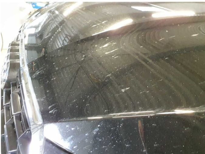
Damage 5: Bonnet: Bonnet (Sandstrahleffekt) - Stone chips - Paint
