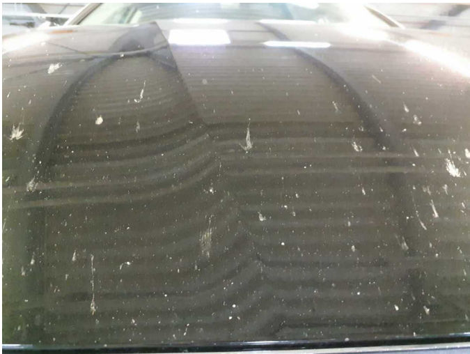
Damage 5: Bonnet: Bonnet (Sandstrahleffekt) - Stone chips - Paint
