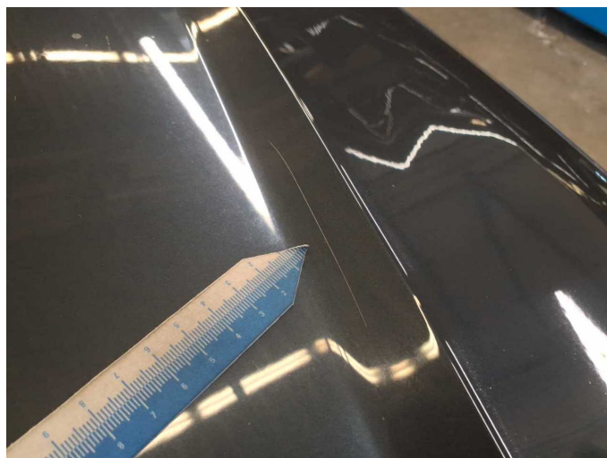
Beschädigung 19: Motorhaube: Motorhaube - Kratzer - lackieren
