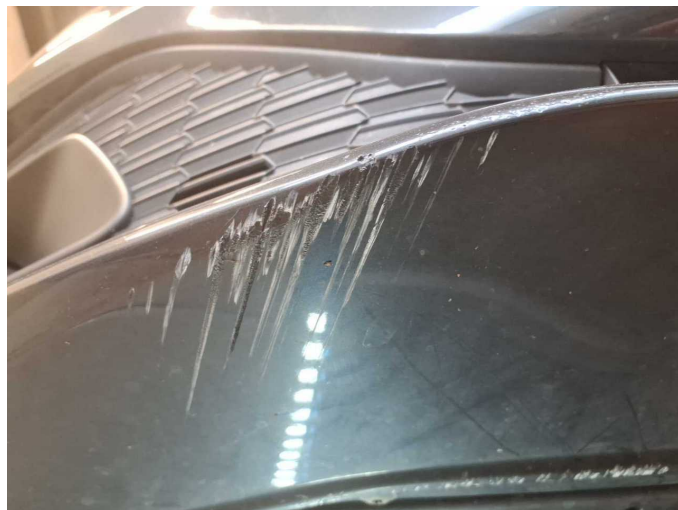
Beschädigung 18: Stossfänger vorn: Stossfänger vorn - Kratzer - lackieren
