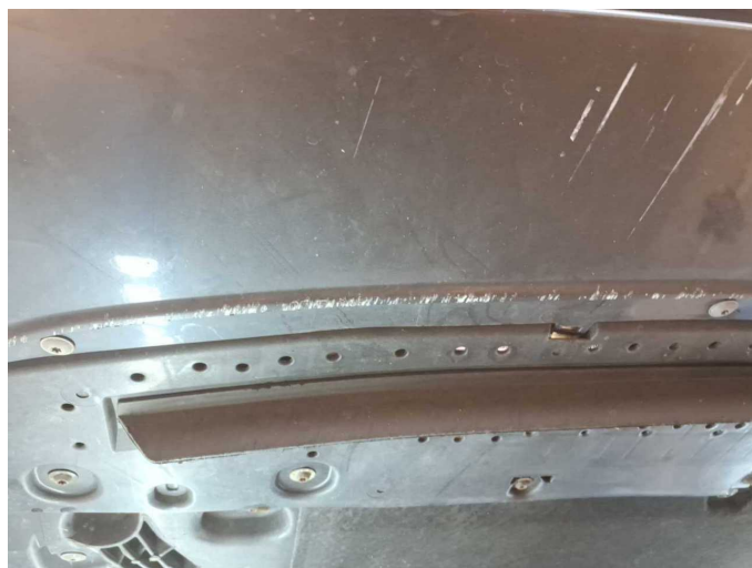
Beschädigung 18: Stossfänger vorn: Stossfänger vorn - Kratzer - lackieren
