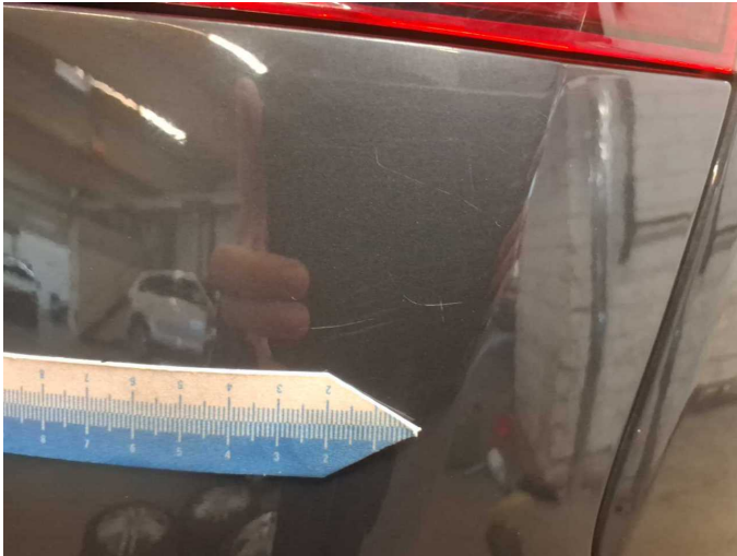
Beschädigung 17: Stossfänger hinten: Stossfänger hinten - Kratzer - lackieren
