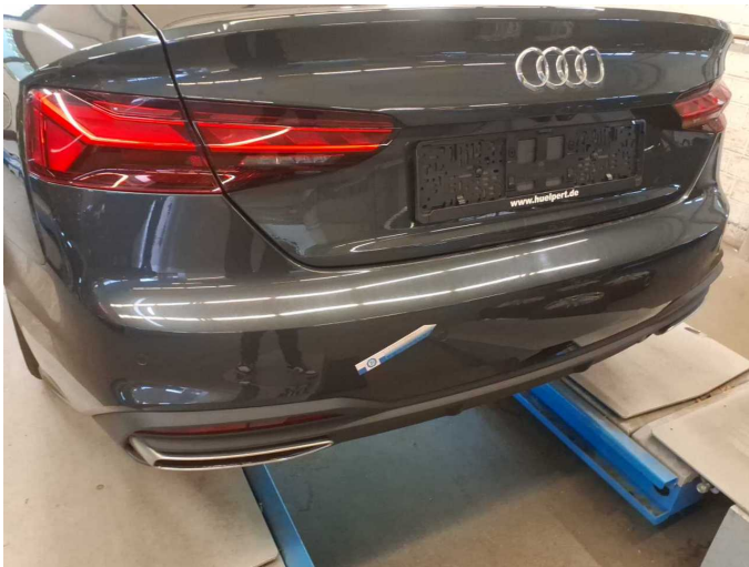
Beschädigung 17: Stossfänger hinten: Stossfänger hinten - Kratzer - lackieren
