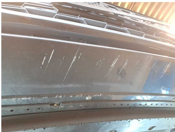
Beschädigung 18: Stossfänger vorn: Stossfänger vorn - Kratzer - lackieren
