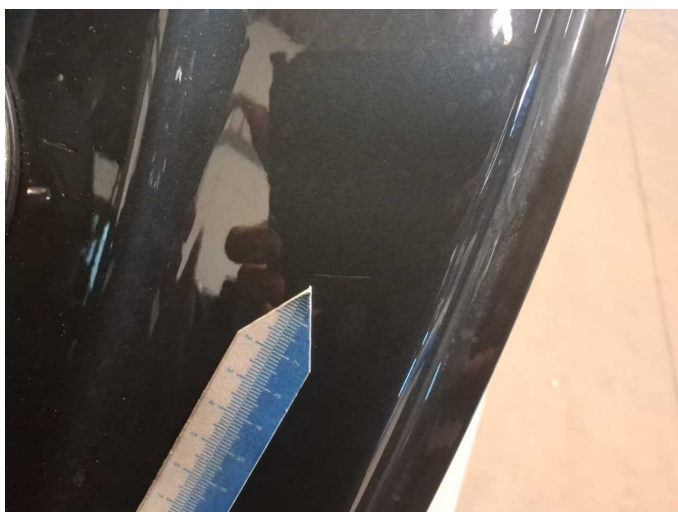
Beschädigung 4: Seitenwand links: Einstieg - Kratzer - Smart Repair
