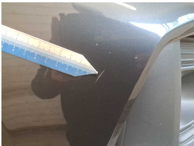
Beschädigung 18: Stossfänger vorn: Stossfänger vorn - Kratzer - lackieren
