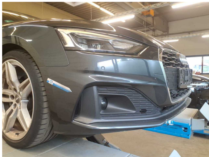
Beschädigung 18: Stossfänger vorn: Stossfänger vorn - Kratzer - lackieren
