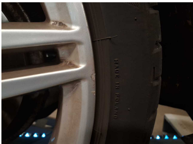
Beschädigung 10: Rad/Reifen: Leichtmetallfelge hinten links - Kratzer - Smart Repair
