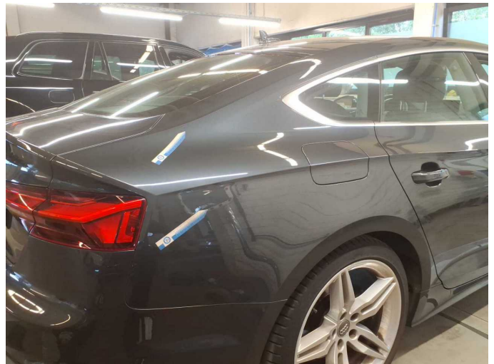
Beschädigung 15: Seitenwand rechts: Seitenwand - Kratzer - lackieren
