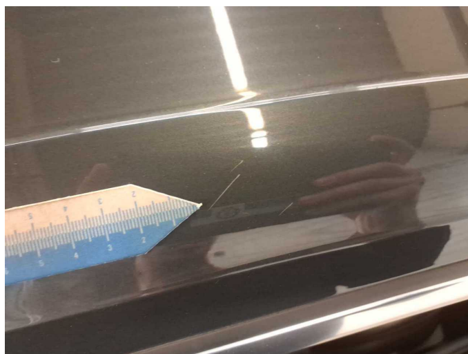
Beschädigung 7: Fahrzeugdach: Dachholm rechts - Kratzer - Smart Repair
