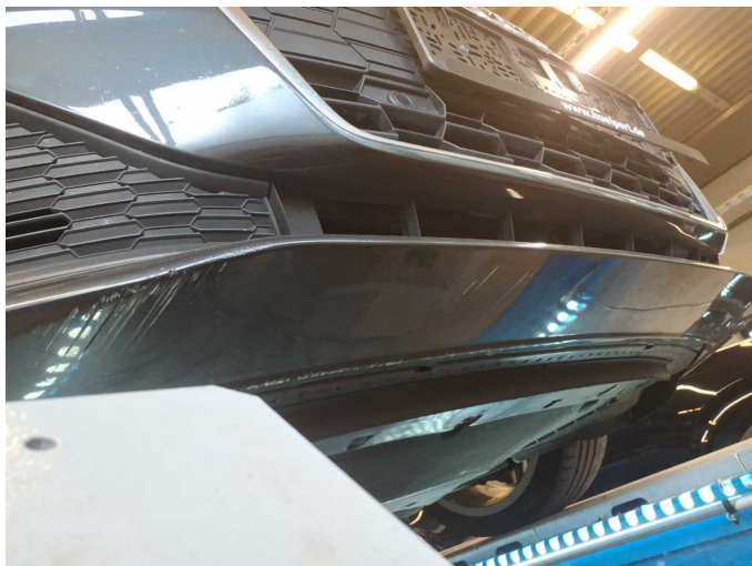
Beschädigung 18: Stossfänger vorn: Stossfänger vorn - Kratzer - lackieren
