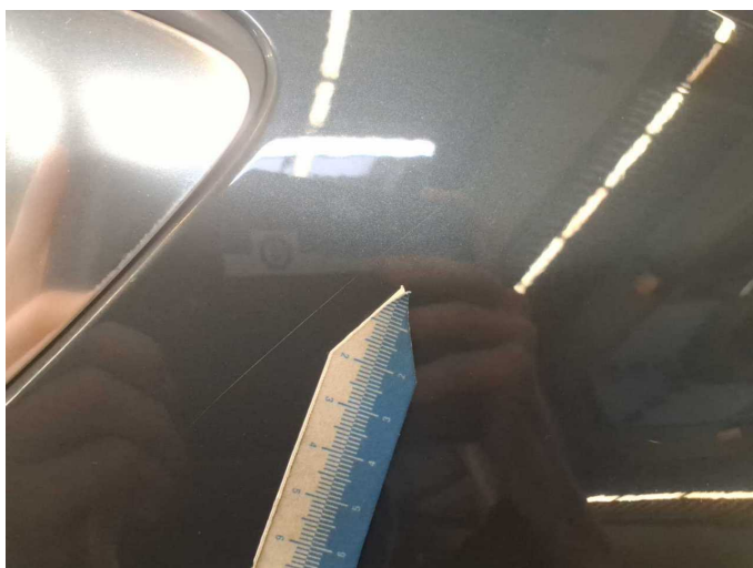
Beschädigung 16: Seitenwand links: Seitenwand - Delle / Lackschaden - instandsetzen und lackieren
