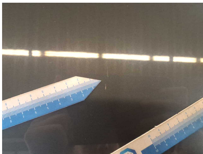
Beschädigung 19: Motorhaube: Motorhaube - Kratzer - lackieren
