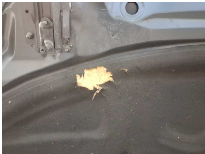
Beschädigung 8: Motorhaube: Dämmmatte - Marderschaden - erneuern
