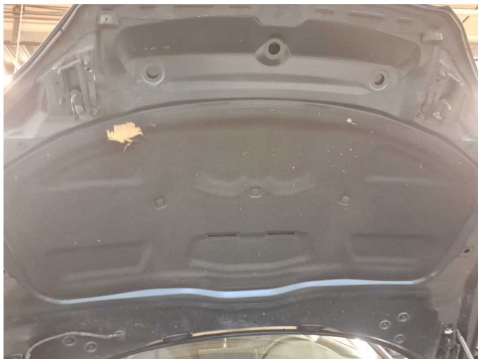
Beschädigung 8: Motorhaube: Dämmmatte - Marderschaden - erneuern
