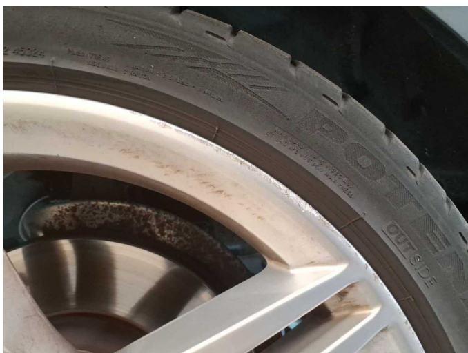
Beschädigung 12: Rad/Reifen: Leichtmetallfelge vorn rechts - Kratzer - Smart Repair
