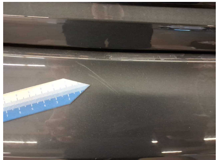
Beschädigung 17: Stossfänger hinten: Stossfänger hinten - Kratzer - lackieren
