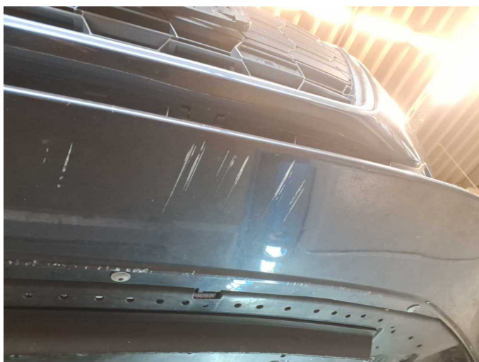
Beschädigung 18: Stossfänger vorn: Stossfänger vorn - Kratzer - lackieren
