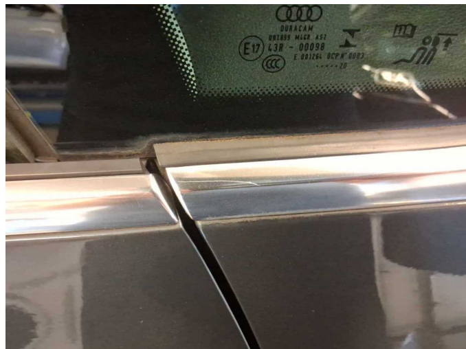
Beschädigung 3: Verkleidungen/Abdeckungen: Zierleiste / Dekorleiste - Kratzer - Wertminderung
