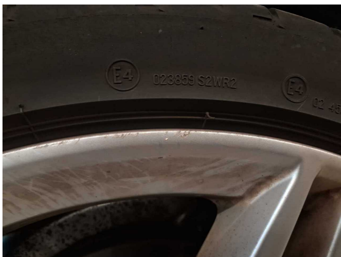
Beschädigung 9: Rad/Reifen: Leichtmetallfelge vorn links - Kratzer - Smart Repair
