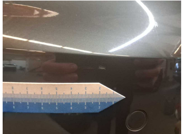
Beschädigung 17: Stossfänger hinten: Stossfänger hinten - Kratzer - lackieren
