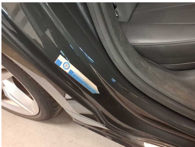
Beschädigung 6: Seitenwand rechts: Einstieg - Kratzer - Smart Repair
