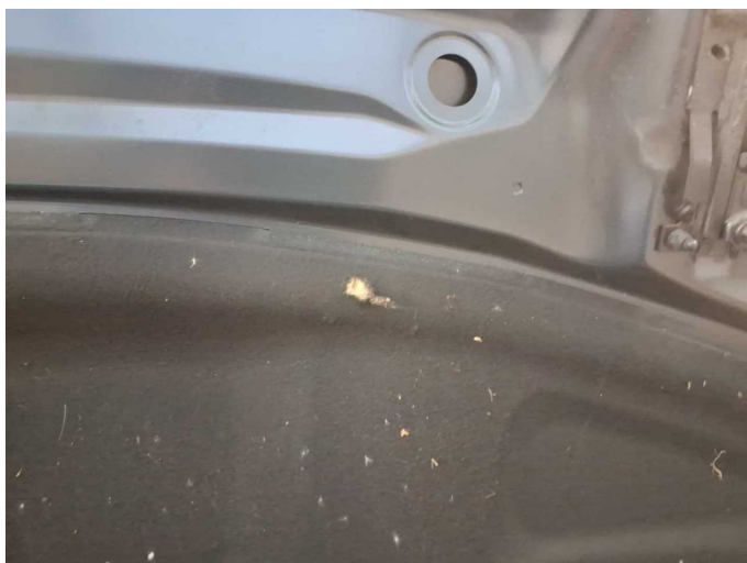
Beschädigung 8: Motorhaube: Dämmmatte - Marderschaden - erneuern
