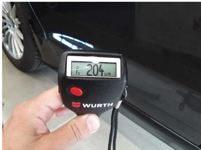
Door - rear right side: 204 \mu\text{m}
