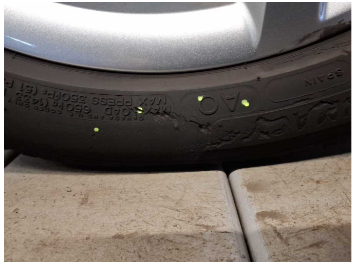
Damage 6: Wheel / tyres: Tyre - front right side (Flanke, nicht fahrbereit) - Damaged - Replace
