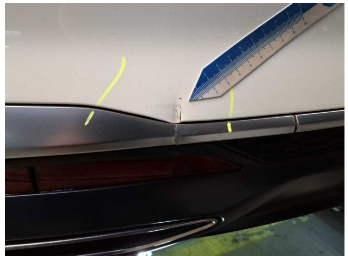
Damage 12: Rear bumper: Rear bumper (mit Spoiler, Verkratzt) - Broken / torn - repair according to calculation
